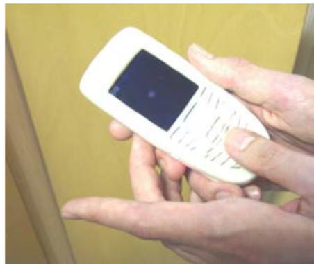
(a) Exemple de mouvement impulsif permettant de déplacer une bille sur le mobile (preuve de concept sous forme de jeu)
