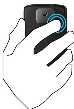
FIGURE 4.7: Tap de l'index au dos pour l'activation de la navigation.
