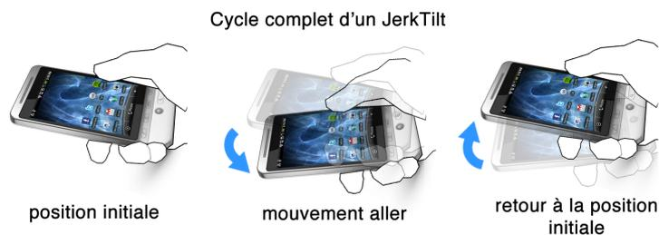
FIGURE 4.11: Cycle complet de réalisation d'un geste de JerkTilts. Le geste part de la position initiale puis revient automatiquement en position initiale en fin de geste.
