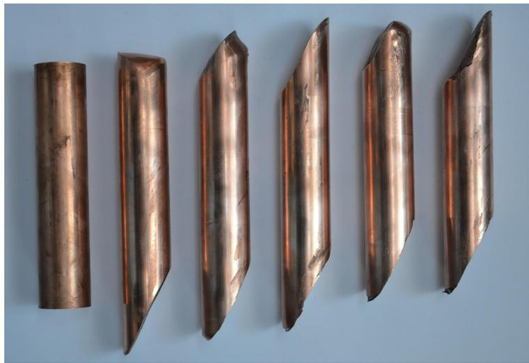
**FIGURE I.1** Lopins dans différents états (de gauche à droite) : état initial, premier lopin extrudé par l'outillage, puis lopins après une, deux, trois et quatre passes
