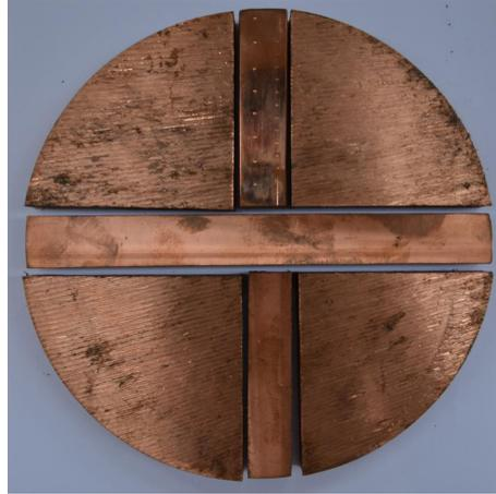
FIGURE A.1 Découpes relatives à l'échantillon utilisé pour les mesures de dureté
