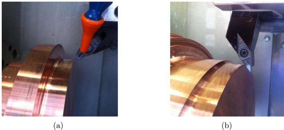
FIGURE 10.20 Essais de coupe dans le bec sur coin : (a)  $r_\epsilon = 3$  mm ; (b)  $r_\epsilon$  infini (arête rectiligne)
