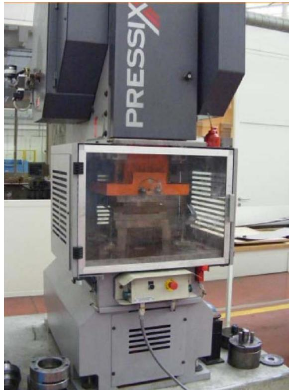
**Fig. 2.10.** Presse mécanique (PRESIX) à Arts et Métiers ParisTech, Metz.
