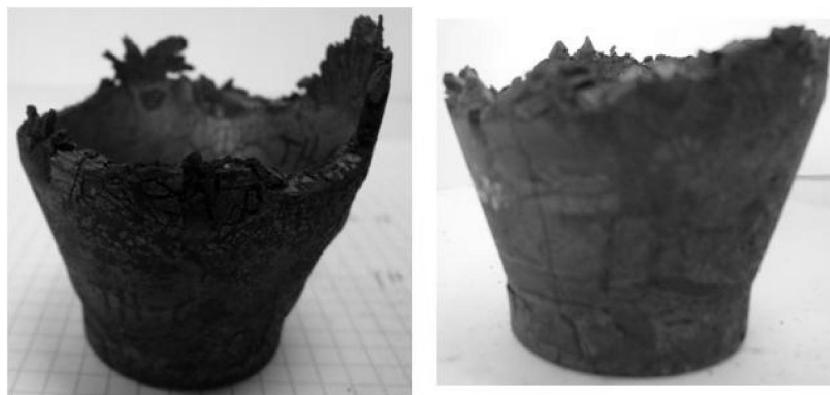
**Fig. 4.4. Ecoulements non uniforme dans les pièces thixoforgées.**
