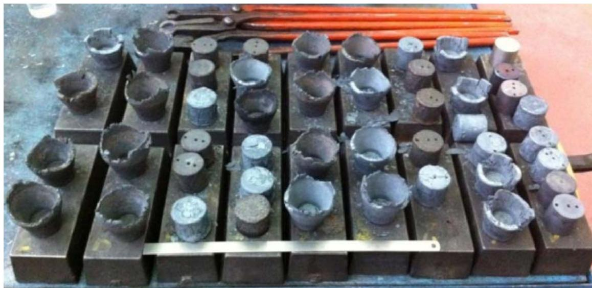
Fig. 4.1. Pièces obtenus par thixoforgeage.
