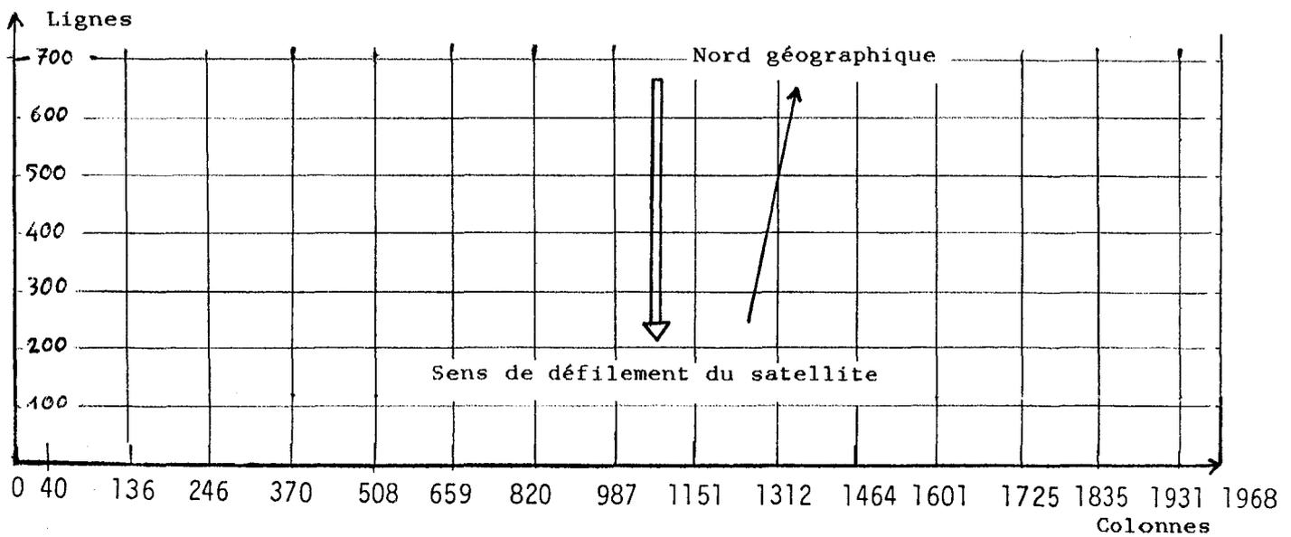
Figure I.13 : Exemple d'image "Quick Look" du satellite NIMBUS-7 avec la grille de sélection montrant la répartition des lignes et des colonnes de l'image et servant à sélectionner la zone d'étude. La non linéarité en colonne est due à la correction de la sphéricité de la terre.
