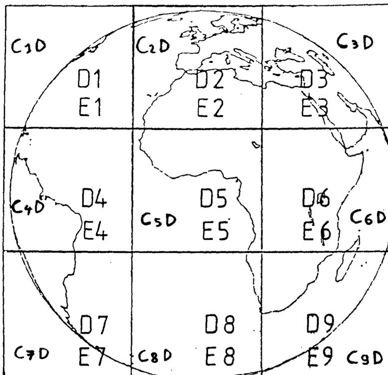
Figure 4.4 Découpage des images METEOSAT pour la dissémination WEFAX.
