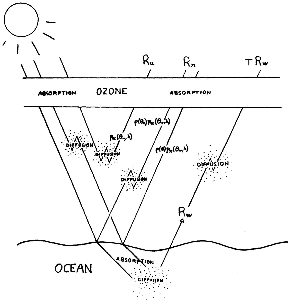
Figure I.11 : Représentation schématique de la décomposition du rayonnement reçu par le capteur (voir équations 7 et 8)
