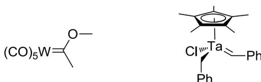
**Schéma 2 :** Exemple de complexes carbéniques de type Fischer<sup>20</sup> (gauche) et Schrock<sup>21</sup> (droite).
