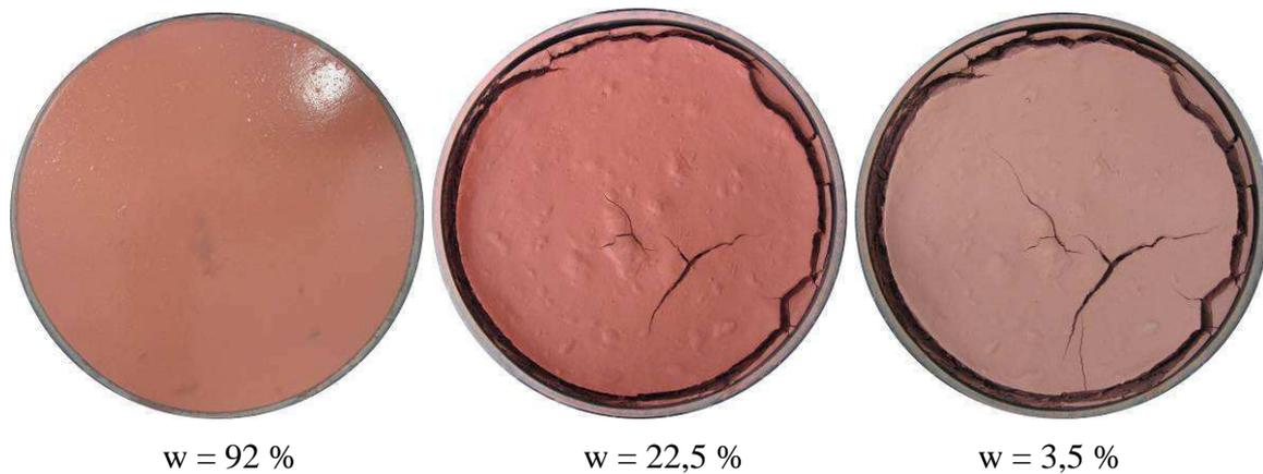
**Figure 3.9 :** Exemples de photos de séchage pour APM remanié D=185 mm, H=24 mm, base rugueuse
