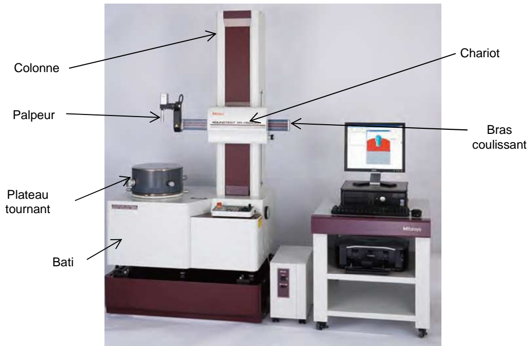
Figure 13: Exemple de machine de mesure de forme conventionnelle : Mitutoyo (RA-H5200)
