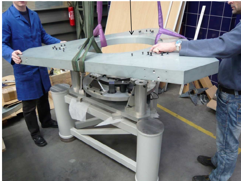
Figure 97: mise en place du plateau principal usiné en tournage
