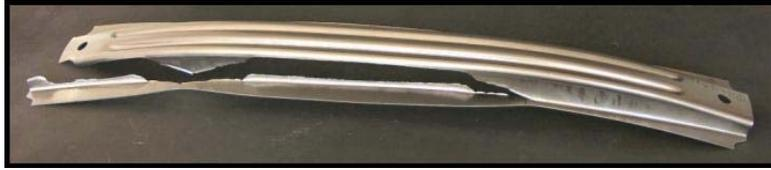
Figure 5. Poutre de pare-choc fissurée au niveau d'un pli après emboutissage
