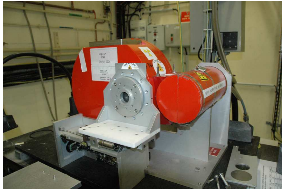
FIGURE 29 – Générateur à rayons X 160 kV (cliché CEA/DAM/DIF).
