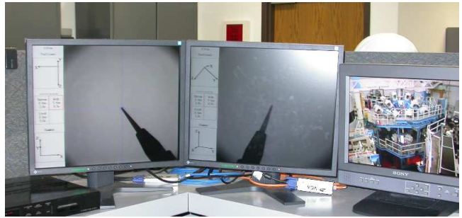
(b) Visualisation de la pointe d'alignement par ombroscopie lors de la phase d'alignement du diagnostic d'imagerie (écran de contrôle des systèmes d'alignement de cible au PC de tir d'OMEGA).
