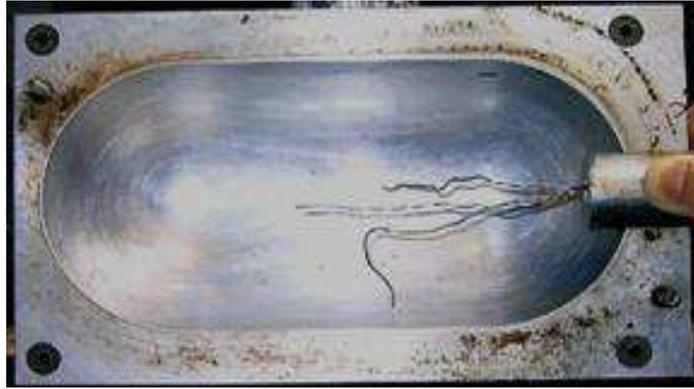
**Figure V.6:** Position des thermocouples pour la détermination des profils des températures.
