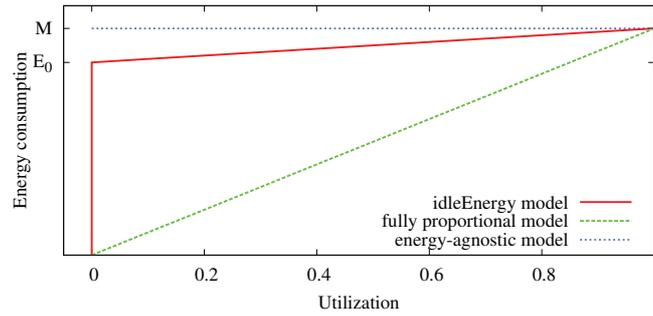
Figure 3: Modèles différents pour la consommation d'énergie de dispositif de réseau, exprimée comme fonction paramétrée de l'utilisation de dispositif.
