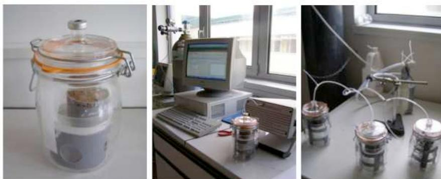
**Figure II.2: Bocal d'incubation, dispositif de mesure de la concentration en CO<sub>2</sub> et système de renouvellement d'air.**
