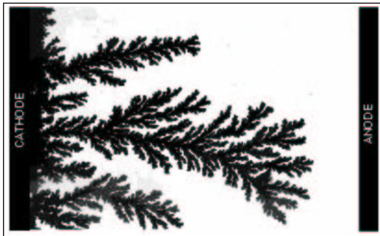
FIG. 1.1 – croissance arborescente d’une cathode de cuivre, plongée dans une solution de sulfate de cuivre (avec la permission de V. Fleury). On voit une partie de la cellule quasi-bidimensionnelle, de taille  $3 \times 2 \text{ mm}^2$ . Les phénomènes impliqués dans cette expérience sont détaillés à la figure 1.2
