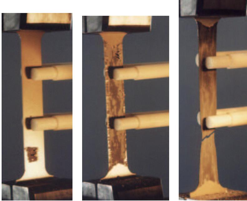
**Figure VII.7 :** *Déroulement de l'essai de traction sur éprouvette oxydée. Traitement à 550 °C, (C1 O<sub>2</sub>, non hydruré).*
