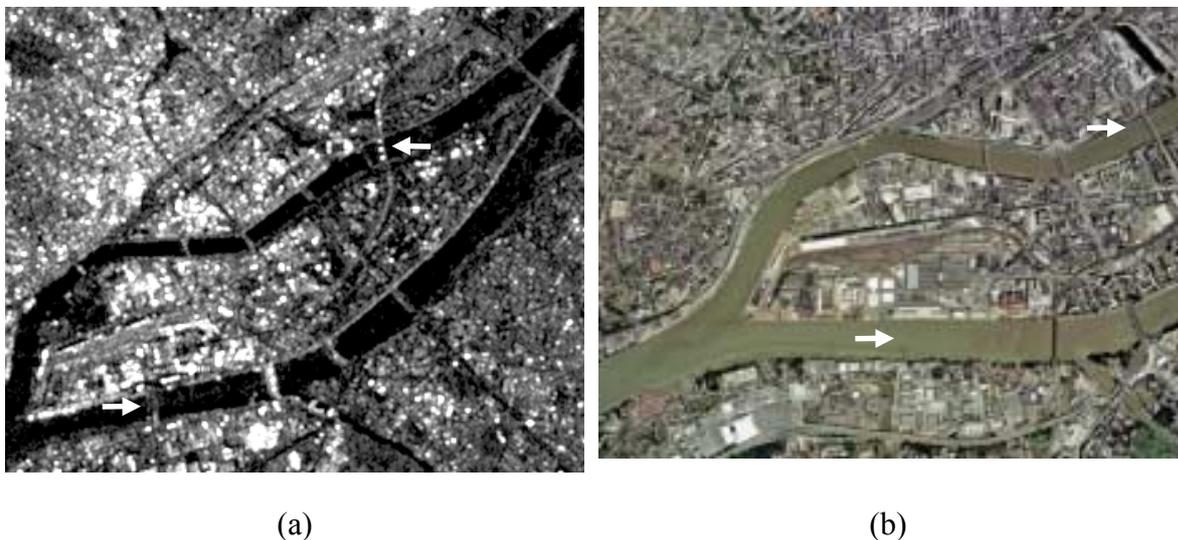
Figure 3.13. Les ponts de l'île de Nantes. (a) Détail d'une image RSO moyennée montrant deux ponts construits postérieurement aux prises de vues aériennes (flèches blanches). (b) Détail d'une vue aérienne montrant l'absence des ponts.
