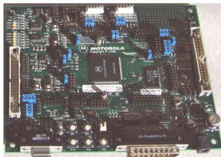
FIG. 2.40 – Photographie du DSP Motorola DSP56F807 utilisé dans nos expériences.
