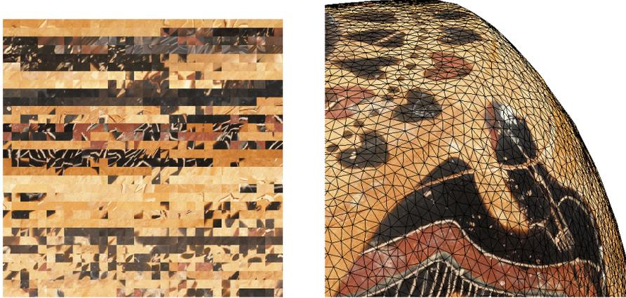
FIG. 3.13 – Exemple de maillage à droite avec la carte de texture associée à gauche.
