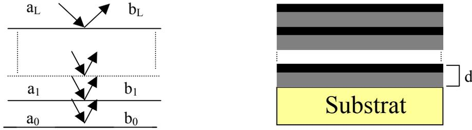
Figure 1 : Schéma d'un empilement multicouche.  $a_j, b_j$  sont les amplitudes de l'onde incidente et de l'onde réfléchie sur la  $j^{\text{eme}}$  interface.
