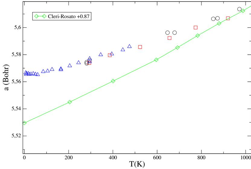
FIG. 8.2 – Paramètre de maille  $a$  en fonction de la température : *Diamants verts* potentiel interatomique de la référence [8], *Cercle Noirs* expérience [111], *Carrés rouges* expérience [156], *Triangles bleus* [110].
