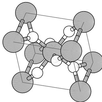
FIG. 2.3 – Structure de la phase rutile de TiO<sub>2</sub>. Grandes sphères : Ti.
