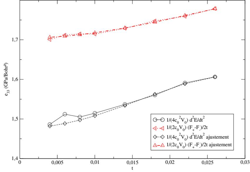
FIG. D.7 –  $Ti \omega - e_{33}$  (GPa/Bohr<sup>2</sup>) en fonction de  $t$  pour un déplacement interne suivant  $z$  (D.2).
