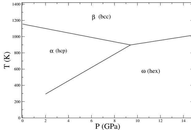
FIG. 2.2 – Diagramme de phase standard du titane.
