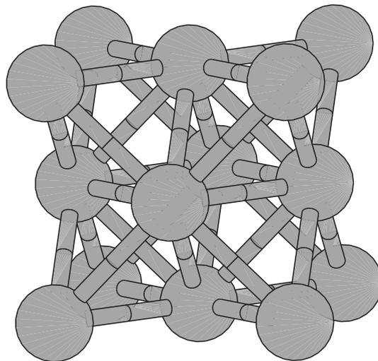
FIG. F.1 – Structure du cuivre (cfc), maille conventionnelle.
