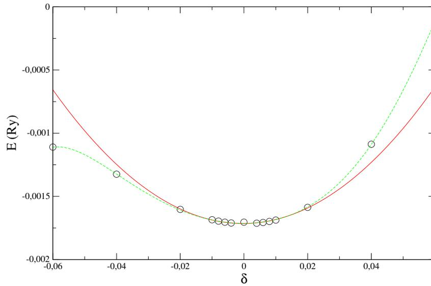
FIG. E.6 – Ti  $\beta$  - Energie totale LDA (Ry) en fonction de la déformation pour un cisaillement (3.28), *cercles noirs* : calcul LDA, *courbe rouge* : ajustement par un polynôme d'ordre 2, *tirets vert* : ajustement par un polynôme d'ordre 6.
