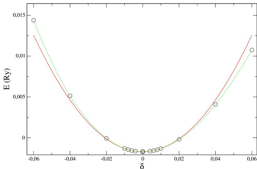
FIG. E.1 – Ti  $\beta$  - Energie totale LDA (Ry) en fonction de la déformation pour une dilatation (3.26). *Cercles noirs* : calcul LDA, *Trait rouge* : ajustement par un polynôme d'ordre 2, *Tirets vert* : ajustement par un polynôme d'ordre 6.
