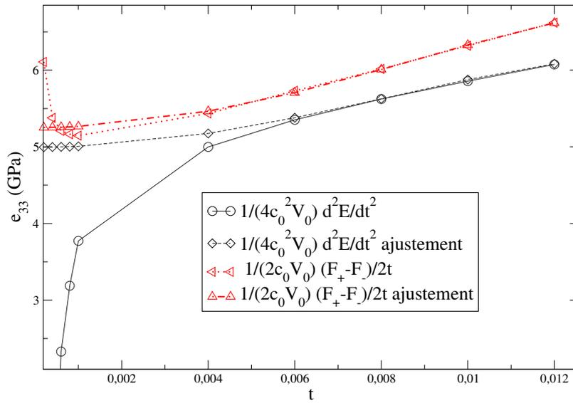
FIG. D.2 – Ti  $\alpha$  -  $e_{33}$  (GPa/Bohr<sup>2</sup>) en fonction de  $t$  pour un déplacement interne suivant  $z$  (D.1).
