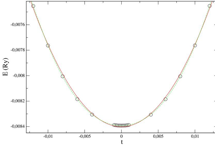
FIG. D.1 – Ti  $\alpha$  - énergie totale LDA (Ry) en fonction de  $t$  pour un déplacement interne suivant  $z$  (D.1) : *Cercles noirs* : calcul LDA, *Trait rouge* : ajustement par un polynôme d'ordre 2, *Tirets vert* : ajustement par un polynôme d'ordre 6.
