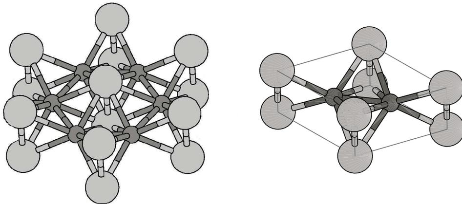
FIG. 2.3 – Structure de la phase  $\omega$  du titane (hex), maille conventionnelle et maille élémentaire. En gris les atomes de type A sur le plan  $z = 0$  et en noir les atomes de types B sur le plan  $z = 1/2$  (cf. tab. 2.1). Les atomes B sont représentés avec un plus faible diamètre pour la visibilité de la structure.
