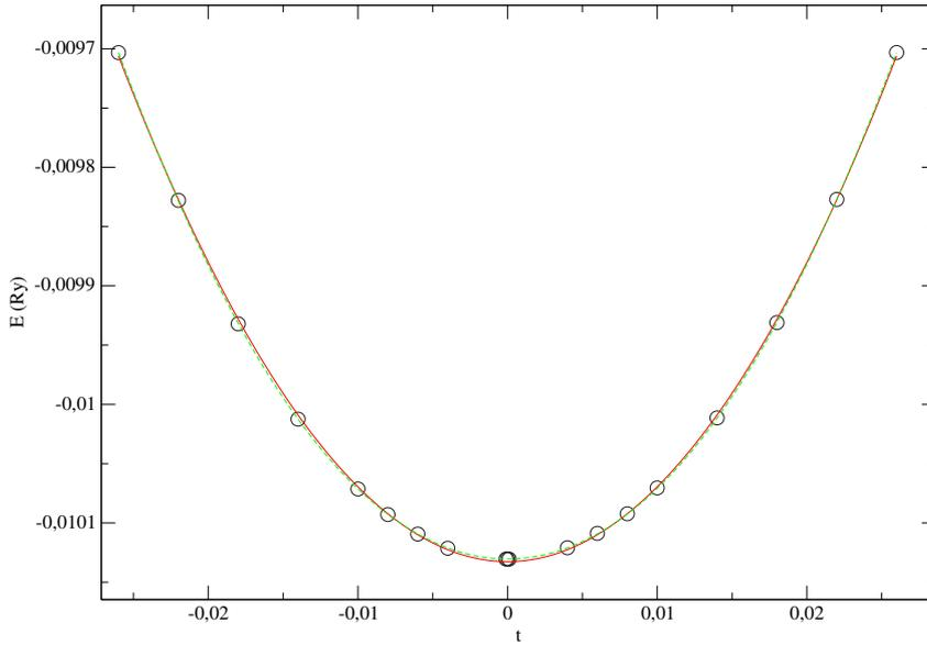
FIG. D.6 – Ti  $\omega$  - énergie totale LDA (Ry) en fonction de  $t$  pour un déplacement interne suivant  $z$  (D.2) : *Cercles noirs* : calcul, *Trait rouge* : ajustement par un polynôme d'ordre 2, *Tirets vert* : ajustement par un polynôme d'ordre 6.
