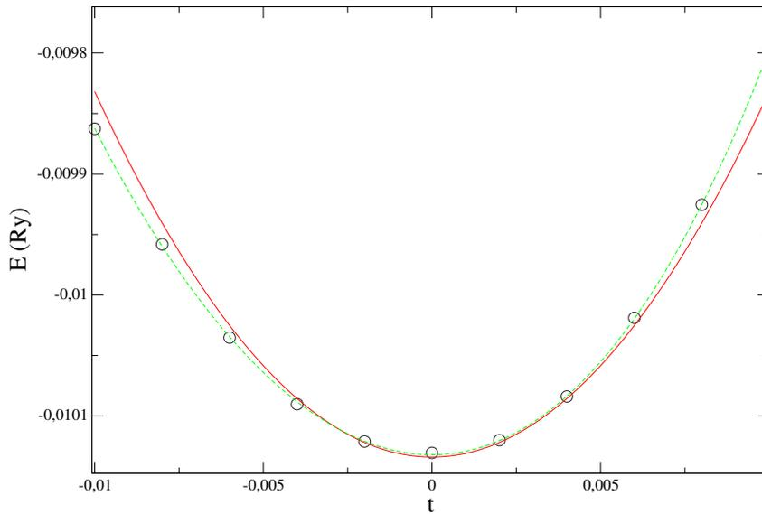
FIG. D.3 – Ti  $\omega$  - énergie totale LDA (Ry) en fonction de  $t$  pour un déplacement interne suivant  $y$  (7.29). Cercles noirs : calcul, Trait plein rouge : ajustement par un polynôme d'ordre 2, Tirets vert : ajustement par un polynôme d'ordre 6.
