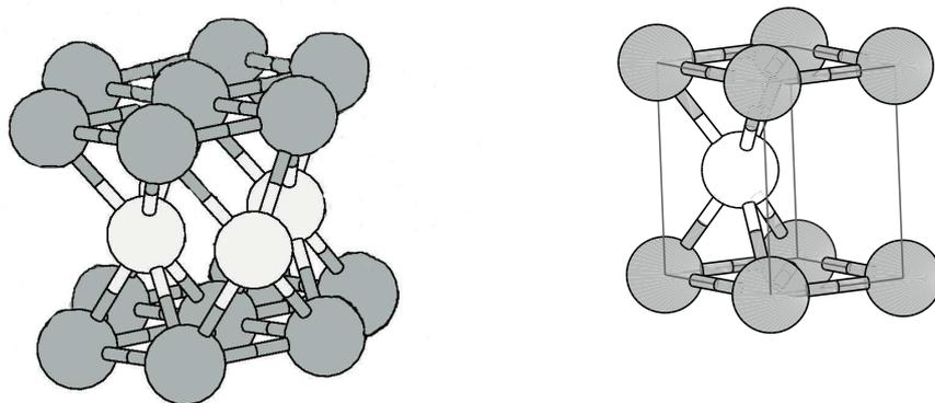
FIG. 2.2 – Structure de la phase  $\alpha$  du titane (hcp), maille conventionnelle et maille élémentaire. En blanc les atomes sur le plan  $z = 3/4$  et en gris sur le plan  $z = 1/4$  (cf. tab. 2.1). Pour plus de clarté, nous avons ramené un atome à l'origine.
