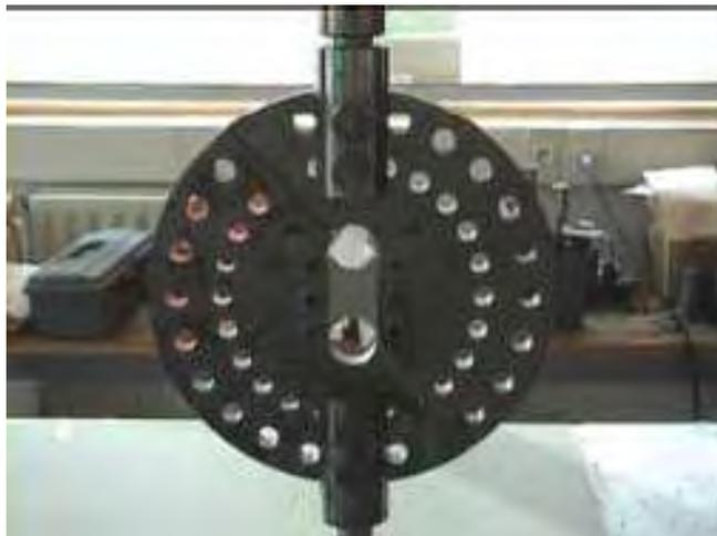
Fig. V-75 Montage expérimental des essais Arcan [19].
