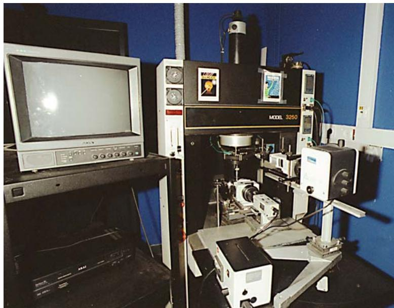
**Figure II- 13:** Le rhéomètre contra-rotatif, vue d'ensemble.
