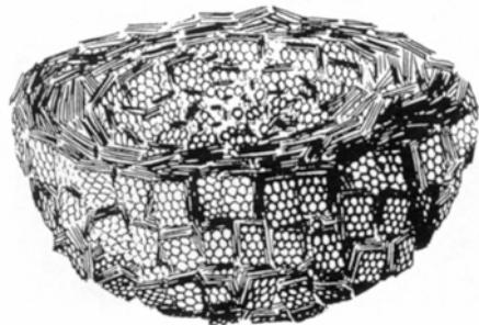
**Figure II- 1:** Vue en coupe d'une particule de noir de carbone (d'après [Heidenreich, et al. 1968]).
