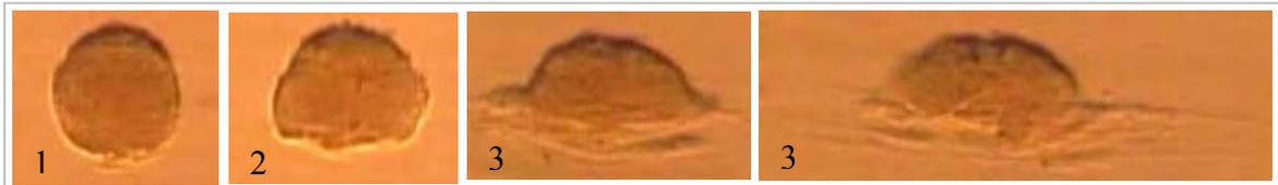
Figure VI- 3 : Séquences de délitement sur un agglomérat de silice Z1115MP totalement infiltré, de rayon initial  $R_0=35 \mu\text{m}$ ,  $\dot{\gamma}=95 \text{ s}^{-1}$ ,  $\tau_c^D=342 \text{ kPa}$
