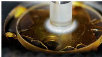
*Figure III- 1 : Image de la cellule contra-rotative après une expérience de cisaillement où l'écoulement a été perturbé*
