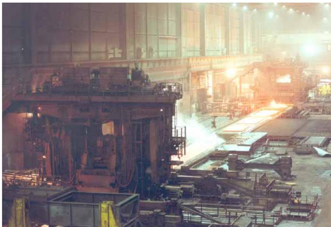
Fig. 2 Vue du laminoir de Dillingen. A l'avant-plan se trouve la cage finisseuse, à l'arrière plan le dégrossisseur et entre les deux la table d'attente
