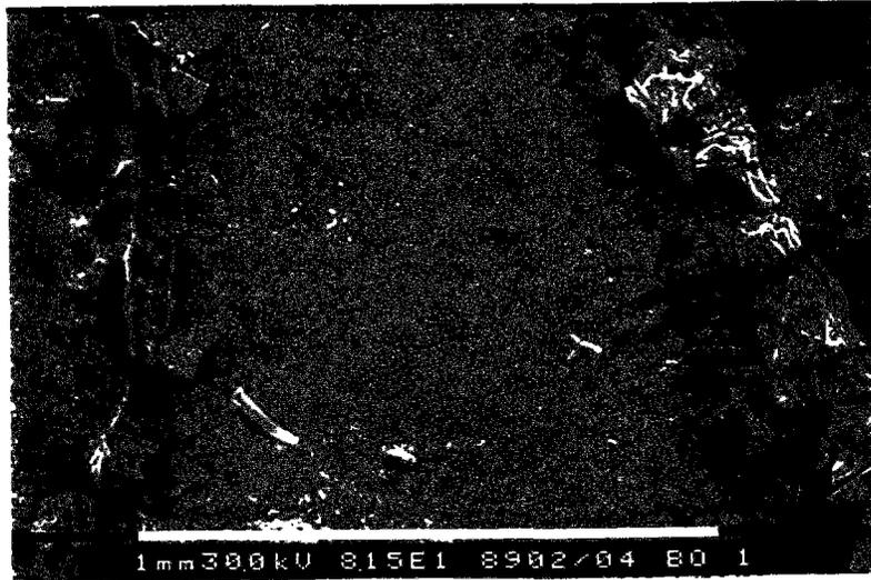
**photo 1** : Image obtenue au M.E.B. (du L.C.P.C.) par électrons secondaires (grossissement x 80), sur la surface sciée d'un échantillon de béton "BO" âgé de 3 ans et conservé à H.R. = 100 %, jusqu'à la date du traitement préalable à l'observation (séchage sous vide et métallisation à l'or).
