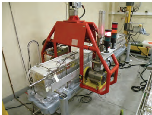
Figure 2-62 : mesure de gammadensimétrie sur une poutre
