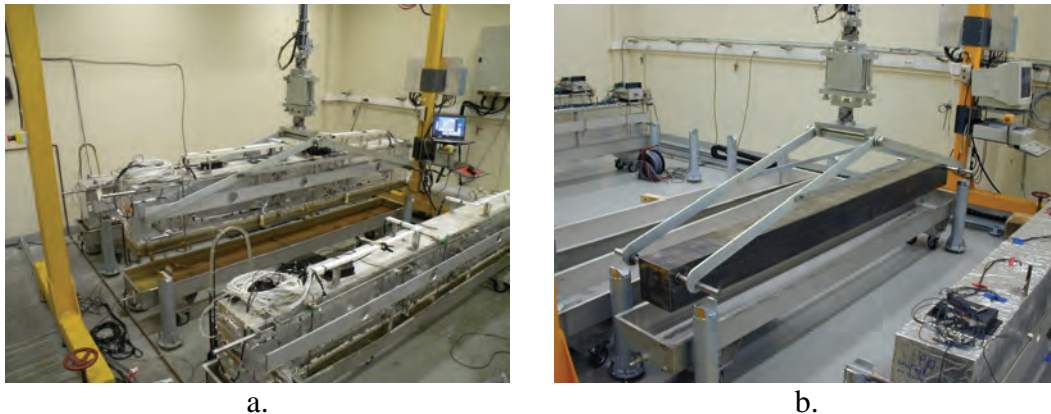
Figure 2-61 : banc de pesée (a. pesée d'une poutre ; b. pesée de la poutre étalon)
