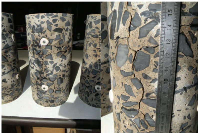
Figure 3-22 : fissuration des éprouvettes R2_GLA après 130 jours d'exposition
