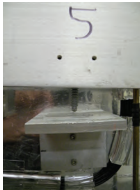
Figure 4-34 : rotation d'une section située à 0,4 m de l'about Nord de P2 après 329 jours de suivi
