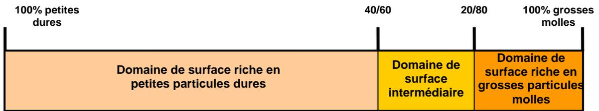
Figure 52 - Domaines de morphologies observées en fonction de la proportion relative en particules
