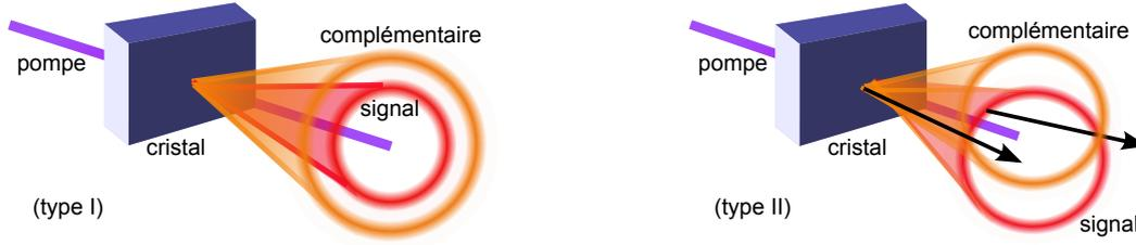
FIGURE 1.5 Conversion paramétrique de type I (les faisceaux signal et complémentaire ont alors la même polarisation) et de type II (les faisceaux signal et complémentaire ont des polarisations orthogonales, les flèches noires à l'intersection des 2 cônes désignent la paire de modes intriqués).
