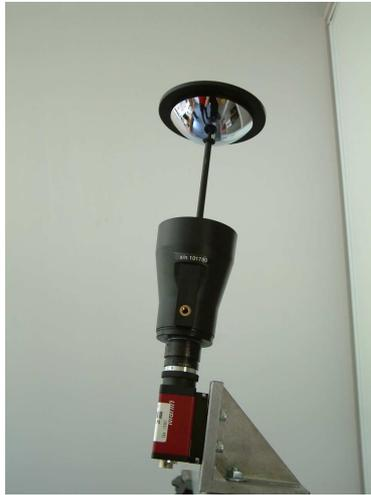
FIG. 3.2 – Caméra omnidirectionnelle catadioptrique.
