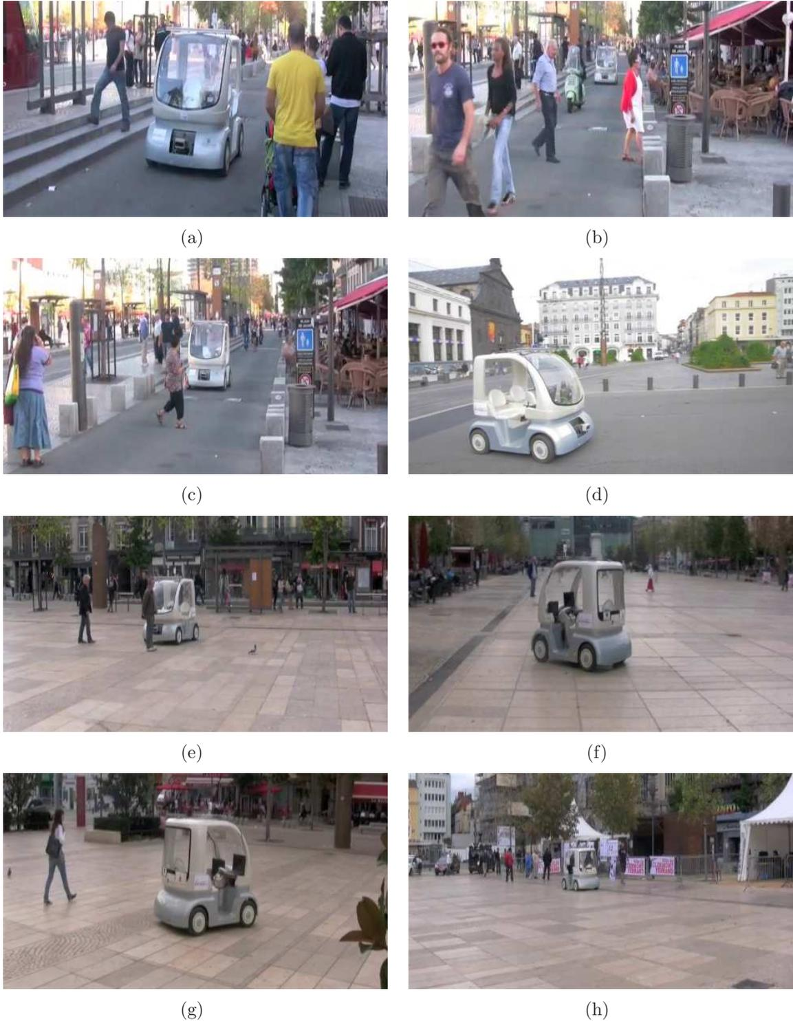
FIG. 8.8 – Quelques images capturées lors d'expériences de navigation autonome à Clermont-Ferrand. (a),(b),(c), des piétons. (d),(f),(g),(h) navigation sur la place.(e), détection d'obstacle.
