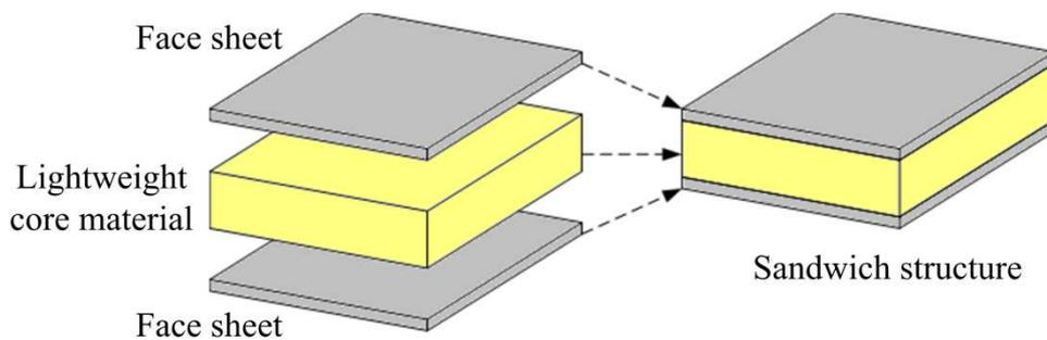
Fig. 1 : Sandwich structures.
