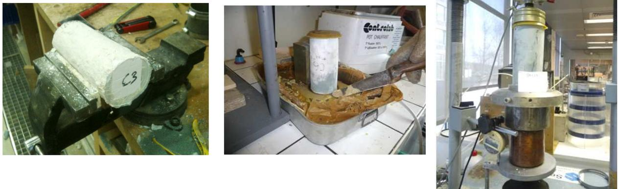
**Figure IV-14 – Surfaçage au soufre des tronçons de colonne avant l'essai de résistance à la compression simple**
