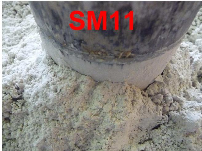
*Figure III-37 – Vue de l'interface sol-colonne au démontage (essai SM11,  $\delta_c = 800\mu\text{m}$ )*
