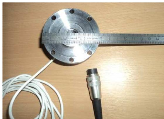
*Figure II-14 - Capteur de force 20 kN*
