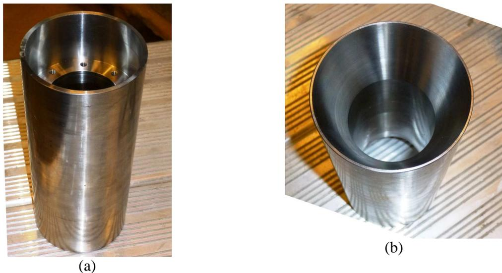
*Figure II-10 - Sabot inférieur : (a) vue de la partie supérieure ; (b) vue de la partie inférieure biseautée*
