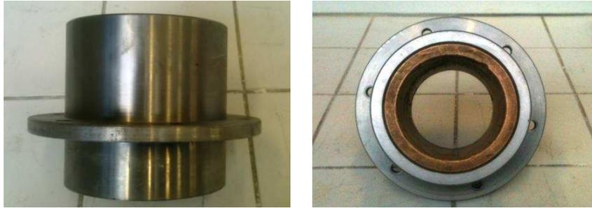
*Figure II-4 – Vue de l'anneau de guidage avec bague en bronze*
