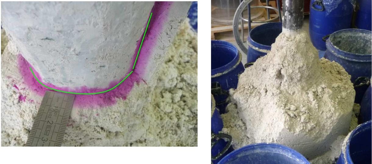
*Figure III-26 - Zone d'interface entre la colonne et le sol environnant*
