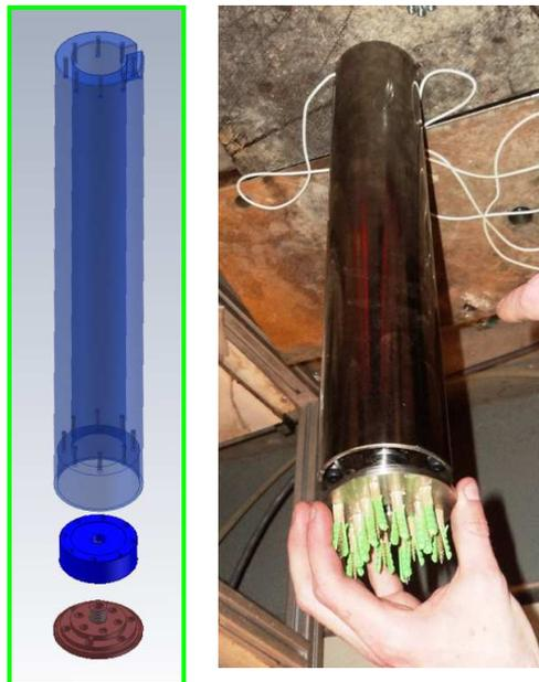
*Figure II-44 – Préparation de la partie haute de la colonne instrumentée*
