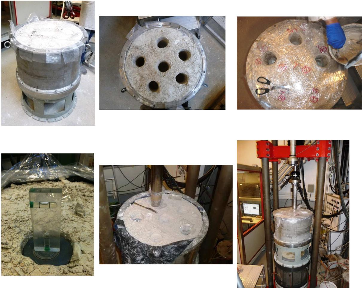
Figure IV-7 - Procédure de mise en place des colonnes au jeune âge
