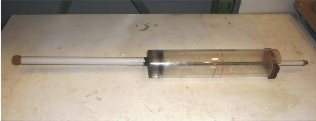
*Figure II-45 - La pompe fabriquée pour la mise en place du soil-mix*
