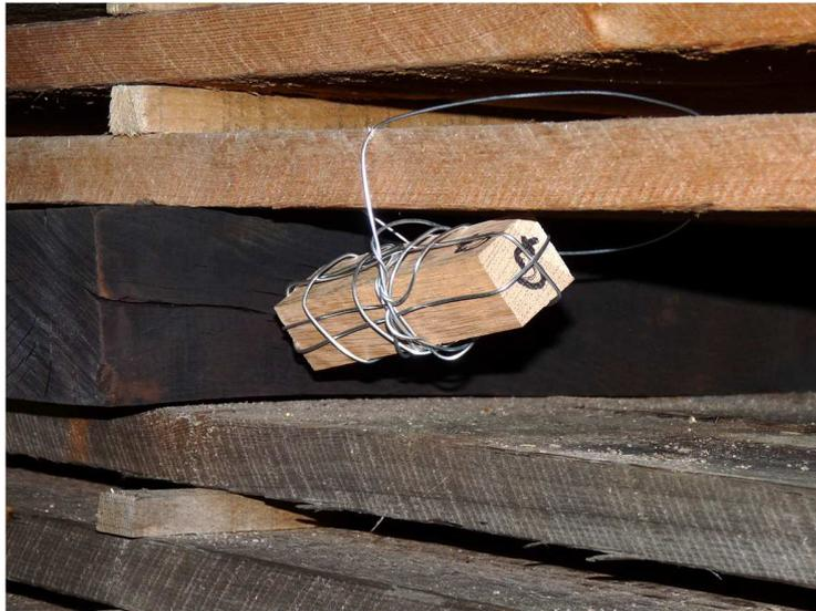
Figure 17 : Éprouvette permettant de mesurer l'intensité de traitement à un endroit donné du four
