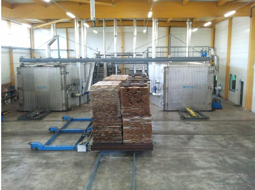
Figure 15 : Fours de traitement thermique du bois de Bois Durables de Bourgogne : technologie Thermowood commercialisée par la société Finlandaise Jartek
