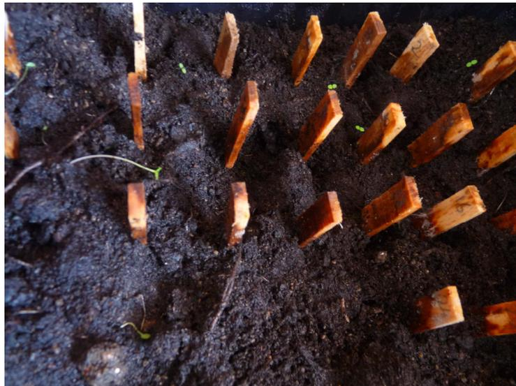
Figure 27 : Éprouvettes de hêtre mises en contact avec un sol préparé pour un essai en classe d'emploi 4 au LaBoMaP
