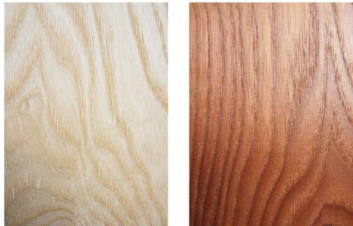
Figure 9 : Frêne non traité (à gauche) et frêne traité thermiquement à 210 °C (à droite)
