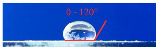
Figure 98 : Angle de contact avec l'eau d'aminosilicates calciques
