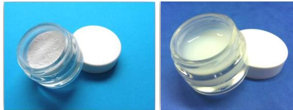
Figure 62 : Particules d'organosilicates sous forme sèche (gauche) et en suspension (droite)
