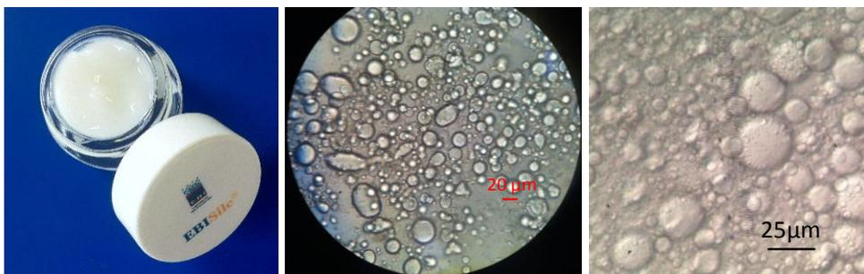
Figure 104 : Emulsion stabilisée par des amino-silicates à base d'isobutylsilane et par l'ajout de gomme xanthane
