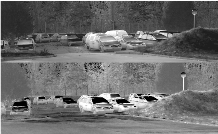
FIGURE 1.7 – Deux images d’une même scène, l’image supérieure étant acquise en bande III, et l’image inférieure en bande II. De multiples informations peuvent être tirées de ces deux images. Le pare-brise d’une voiture réfléchit le rayonnement IR du ciel : il apparaît noir en bande II (pour laquelle le rayonnement provenant du ciel est très faible), mais plus clair en bande III.
