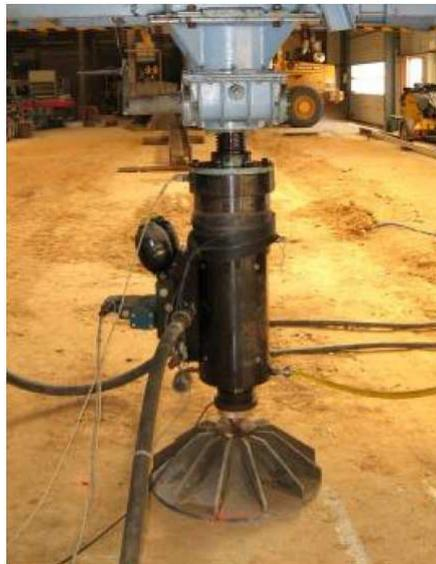
*Figure 2-6 : Vérin de 100 kN appliquant une charge dynamique*
