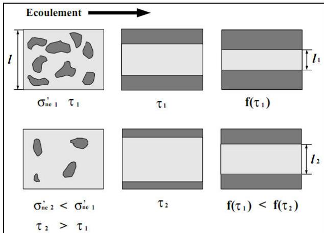
Figure 2.5 : Pour deux niveaux de contraintes normale effective  $\sigma_n^1$  et  $\sigma_n^2$  on construit les largeurs  $l_1$  et  $l_2$  des chenaux hydrauliquement équivalents (Jeong et al., 2006)
