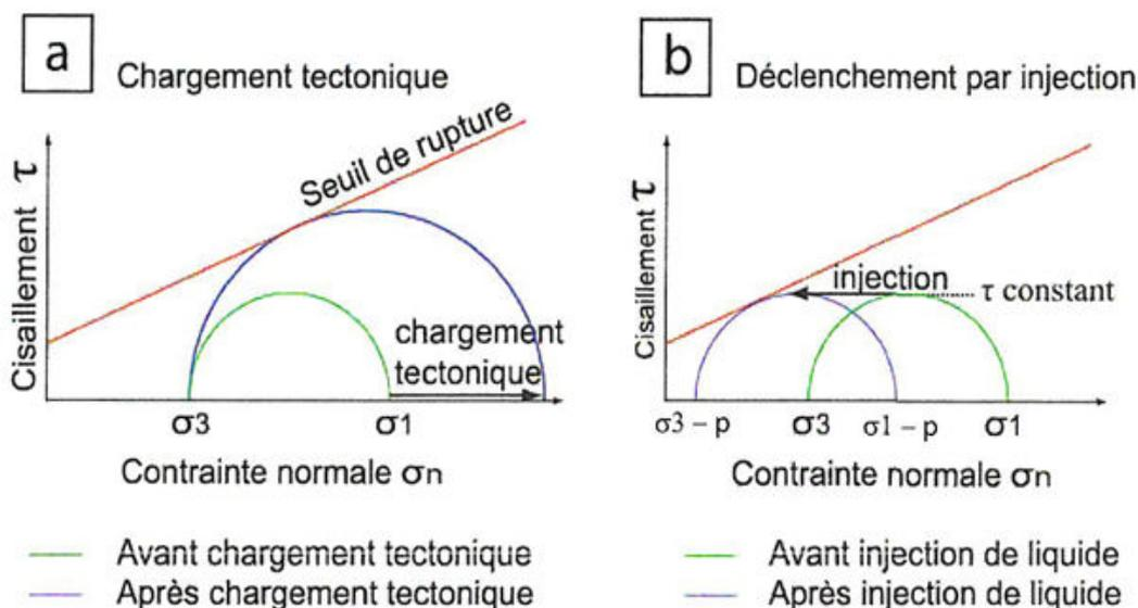
Figure 1.13 : Comparaison des cercles de Mohr entre une charge tectonique normale et une surpression de fluide  $p$ . (a) chargement tectonique simplifié : la contrainte principale augmente et la contrainte minimale est constante, le cisaillement augmente jusqu'à la rupture. (b) Injection de liquide : le cisaillement reste constant mais la contrainte normale effective diminue (D'après Bardainne, 2005).
