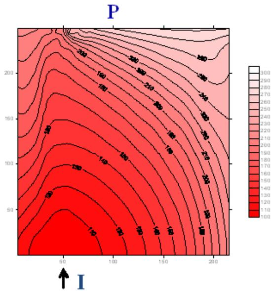
Figure 2.13 : Carte de la température  $\theta_f$  dans le plan de la fracture, obtenue à la date 5 ans.
