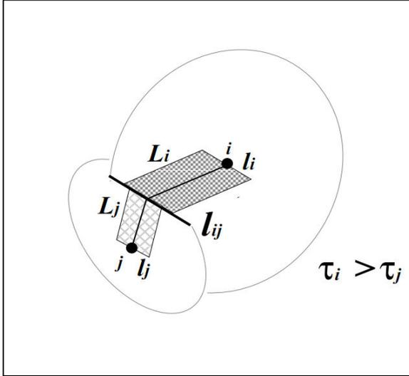
Figure 2.4 : Exemple de deux disques  $i$  et  $j$  connectés. La largeur des liens est fonction de la longueur du segment d'intersection  $l_{ij}$  et du niveau de contrainte normale effective supportée, via les coefficients de degré de séparation  $\tau_i$  et  $\tau_j$  (Bruel, 1990).
