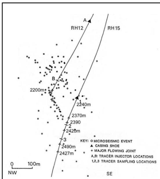
Figure 3.6 : Localisation des événements micro-sismiques durant le test de caractérisation des chemins de circulation (Markland, 1991 et localisation des 6 niveaux producteurs majeurs dans RH15)
