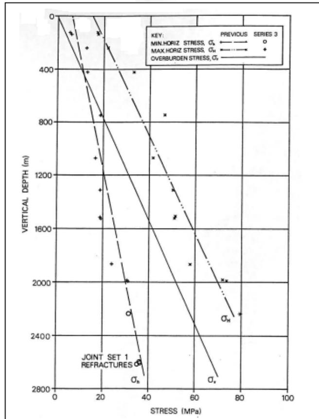
Figure 3.7 : Contraintes « in situ » mesurées en fonction de la profondeur dans le granite de Carnmenellis (Parker, 1989)
