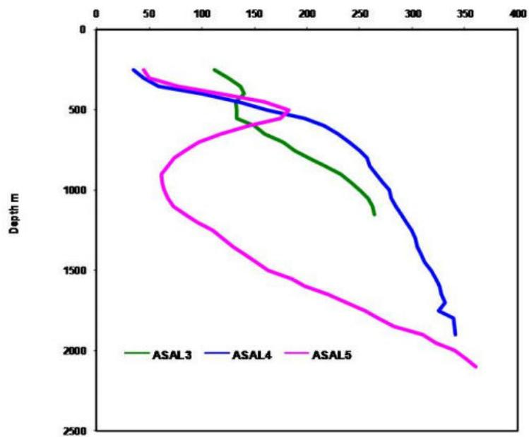
Figure A6 : Profil de température des forages A3, A4, A5 (Aqater, 1989 et cité dans Daher, 2010)
