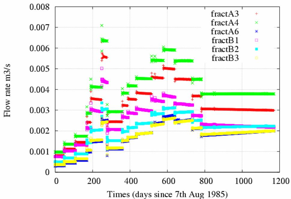
Figure 3.20 : Débit de fluide desservant à travers les 6 fractures majeures de production
