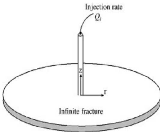
Figure 2.9 : Injection d'un fluide dans une fracture radiale infinie (Mossop, 2001)
