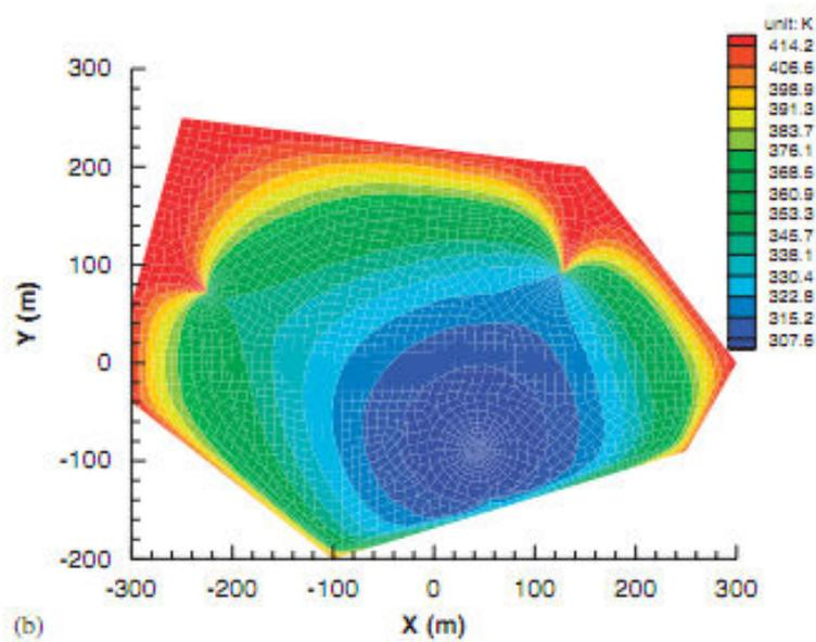
Figure 2.24 : Distributions de la température du fluide dans la fracture lorsque les temps d'injection de fluides sont de 6 mois (haut) et 3 ans (bas) (Zhou et al., 2009)
