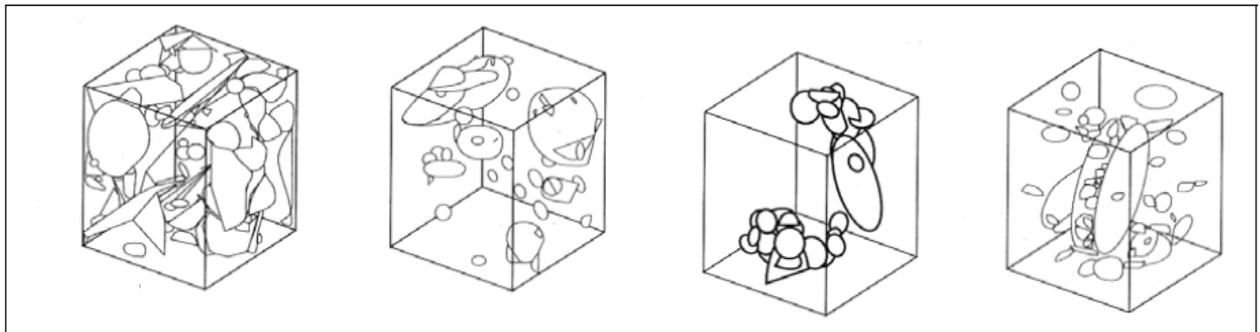
Figure 2.2 : Modèles conceptuels présentant une non uniformité de la densité spatiale des fractures, de gauche à droite : le modèle de poisson stationnaire, le modèle de poisson non stationnaire, le modèle de Levy-Lee fractal et le modèle dit de « war zone » (Dershowitz et Miller, 1995).
