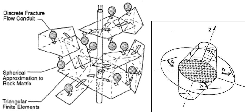
Figure 2.6 : (à gauche) Méthode d'agrégation, d'après Dershowitz et Miller (1995) - (à droite) : Approximation du bloc adjacent à un disque dans FRACAS, par un tronc de cône (d'après Bruel, 1990)
