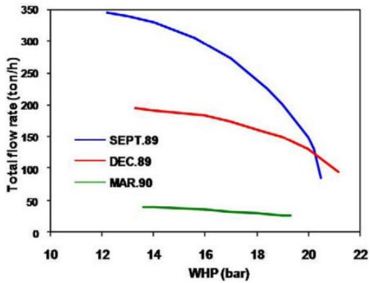
Figure A5 : Courbe de production du forage A3, (Aqater, 1989 et cité dans Daher, 2010)
