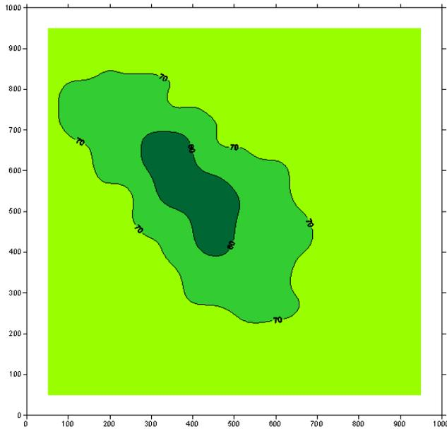
Figure 2.20 : Carte de la température  $T_m$  du réservoir dans la tranche située entre 2400 et 2500 m, qui contient les disques représentant les fractures de la Figure 2.19, à la même date.
