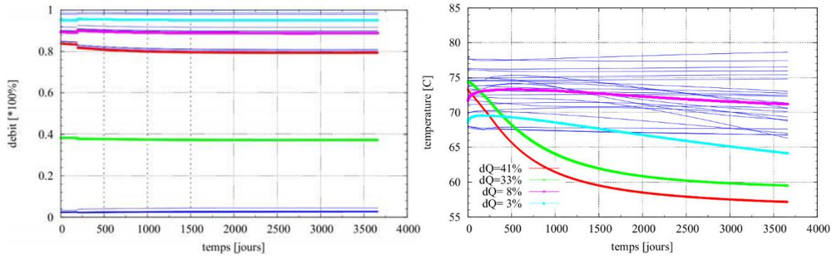
Figure 2.22 : (a) Distribution des débits locaux cumulés dans les trois puits producteurs en % du débit total produit et (b) température de production par niveau producteur au cours du temps
