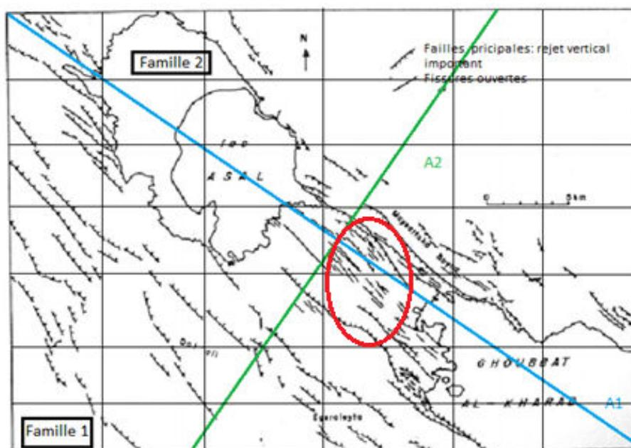
Figure A8 : Champ fissural du rift d'Assal, selon Stieljes (1973). L'axe A1 sépare le réservoir de Fialé et celui du Nord Ghoubhet, l'axe A2 coupe perpendiculairement les principales traces des failles du rift. En rouge, la localisation d'un site potentiel.
