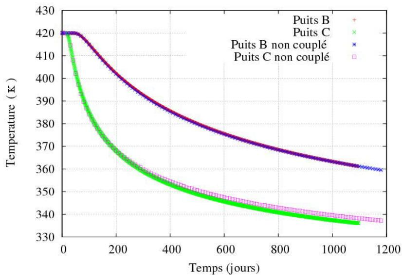
Figure 2.29 : Comparaison des températures de production dans le cas où il y a un couplage entre perméabilité et contrainte normale effective et dans le cas où le couplage est omis pour 3 années d'injection.
