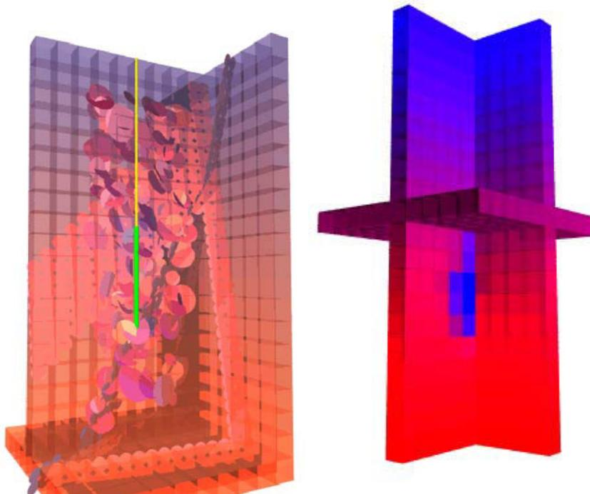
*Figure 2.7 : Vues en écorché d'un réservoir comportant un réseau de fractures et une fracture majeure et exemple de découpage en blocs cubiques de la matrice pour le calcul à long terme du refroidissement dû à une injection en forage (le long du segment vert).*
