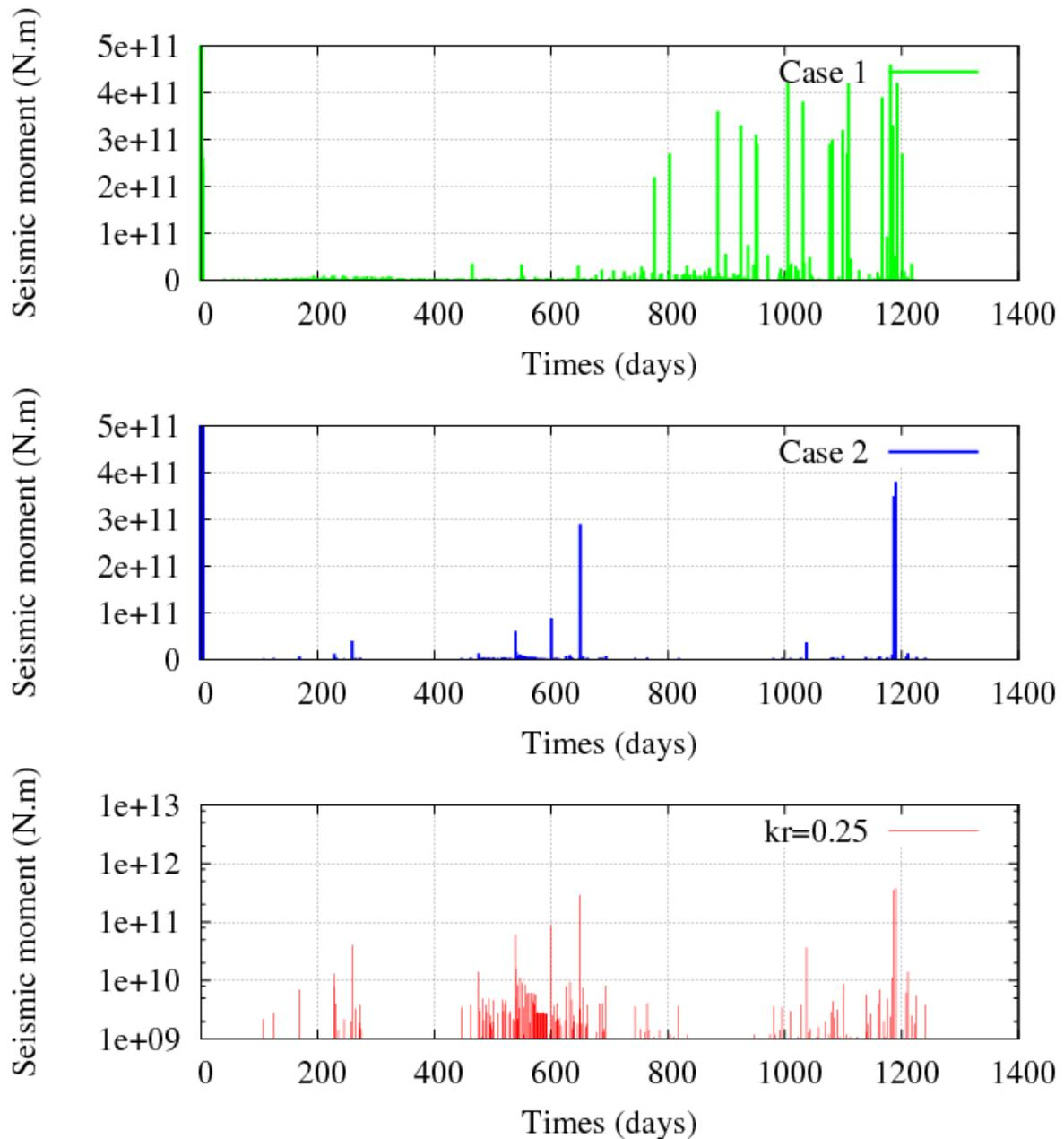
Figure 3.34 : Moments sismiques simulés pour le test de longue circulation. Cas 1 (Haut), avec une pression et température moyenne constante tout au long du test. Cas 2 (Milieu), avec la température et la pression d'injection variables au cours du temps et Cas 3 (Bas), même situation dans une échelle logarithmique pour les moments, montrant mieux l'apparition des événements de rupture en trois bouffées successives.
