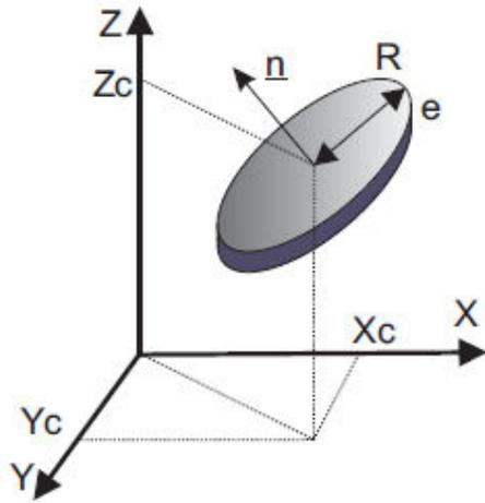
Figure 2.1 : Paramètres définissant une fracture (Baujard, 2005).
