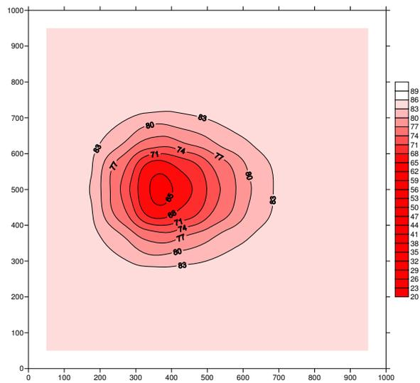
Figure 2.17 : Carte de température  $T^m$  de la matrice dans un plan médian vertical passant par les deux puits à la date 10 ans.
