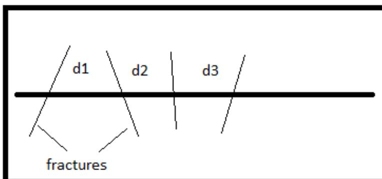
Figure A10 : Définition de la distance inter-fracture (Bourgine et al., 1995) séparant deux traces successives le long d'une ligne d'observation
