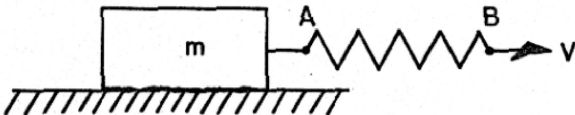
Figure 1.14 : Schéma caractéristique d'une expérience de stick-slip (Byerlee, 1978)
