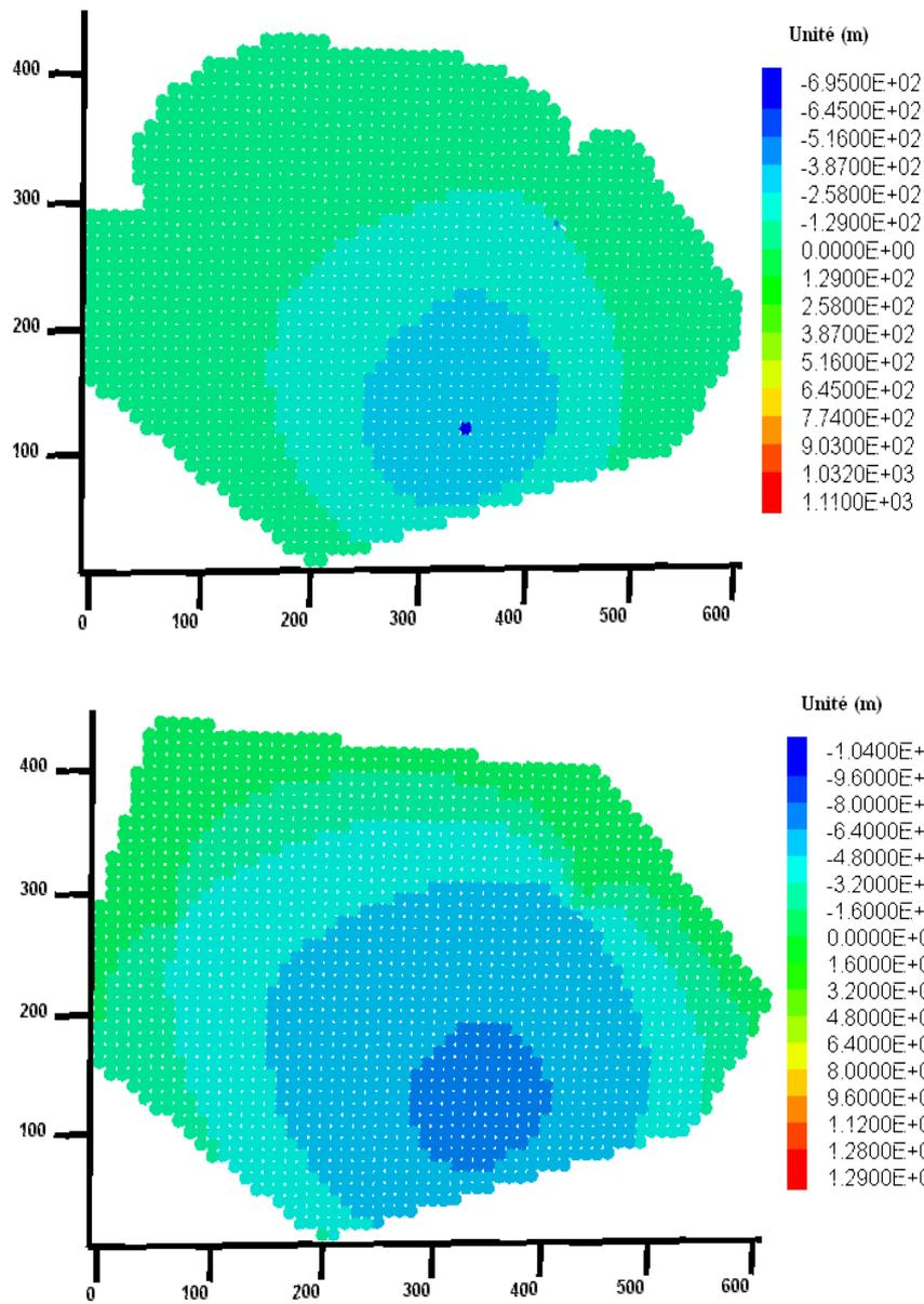
Figure 2.27 : Distributions de la contrainte  $\sigma_{zz}$  exprimées en m de colonne d'eau à la surface de la fracture lorsque les temps d'injection de fluides sont de 6 mois et 3 ans respectivement.
