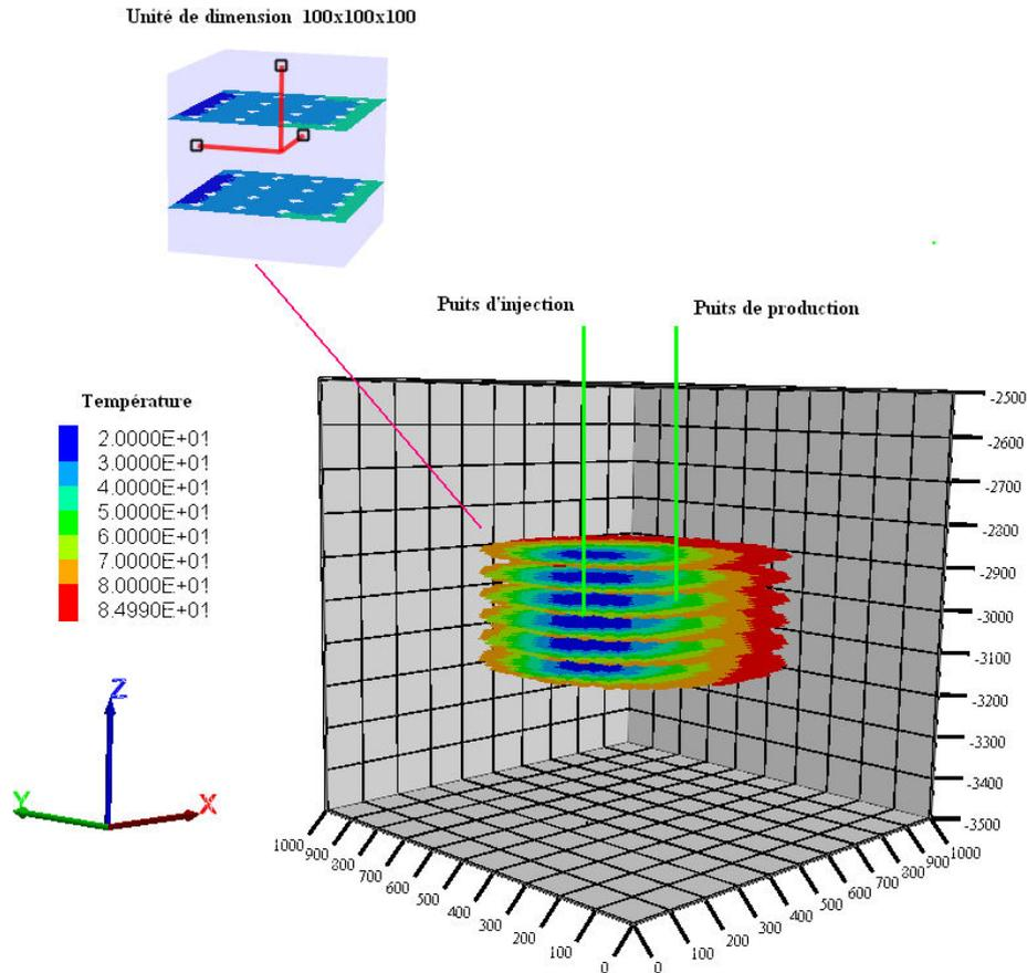
Figure 2.15 : Schéma montrant les 6 fractures horizontales parallèles d'extension finie recoupées par deux puits et emboîtées dans un bloc conducteur de chaleur, de 1 km de côté. Les couleurs donnent la température après 10 ans d'injection d'eau froide à 60 l/s et 20°C et la progression du panache froid. Le zoom est une des unités de 100 m de côté, du bloc continu, recoupant ici 2 des fractures horizontales, elles-mêmes maillées en cellules 'disque' centrées tous les 25 m.
