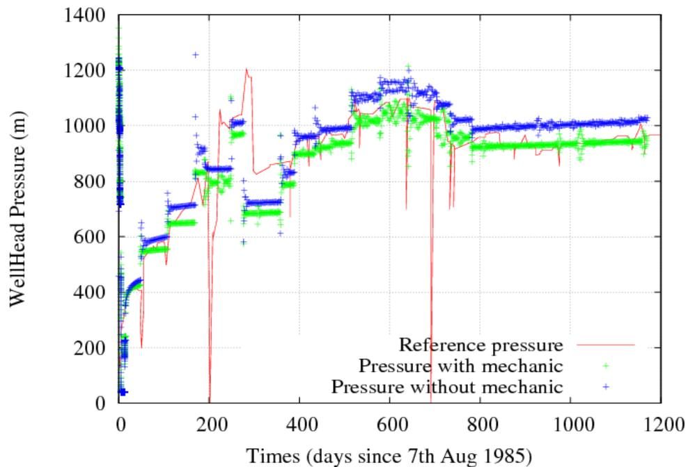
Figure 3.16 : Pression de production du modèle, avec le couplage mécanique (vert) et sans le couplage mécanique (bleu) et données de terrain (rouge) (100 m = 1 MPa)
