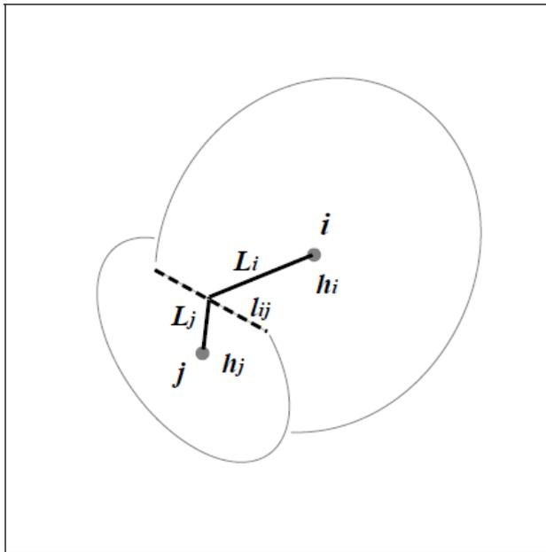
Figure 2.3 : Schématisation des écoulements entre deux disques interconnectés  $i$  et  $j$ , où  $h_i$  et  $h_j$  sont des charges hydrauliques au centre des disques  $i$  et  $j$ .  $l_{ij}$  est le segment d'intersection et  $L_i$  et  $L_j$  sont les longueurs du centre de disques  $i$  et  $j$  au milieu du segment, (Bruel, 1990).
