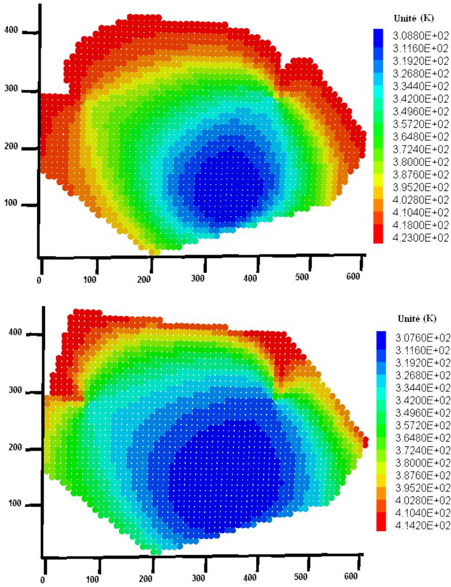
Figure 2.26 : Distributions obtenues avec FRACAS de la température exprimées en K du fluide dans la fracture lorsque les temps d'injection de fluides sont de 6 mois et 3 ans respectivement.
