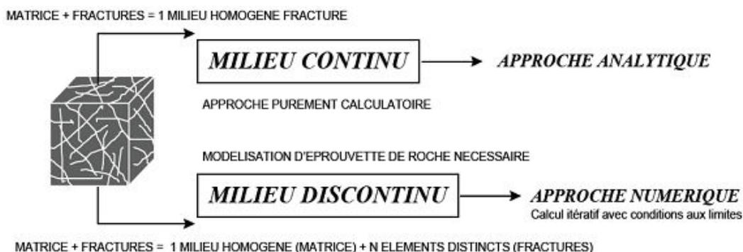
Figure 1.5 : Présentation schématique des deux approches généralement utilisées pour modéliser les milieux à perméabilité de fractures (Sausse, 1998)
