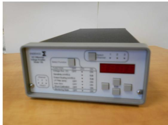
Figure 3-7 Conditionneur pour capteurs de pression ENDEVCO modèle 136
