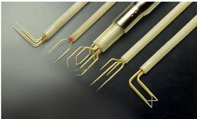
Figure 2-28 Différents types de fils chauds (Dantec)
