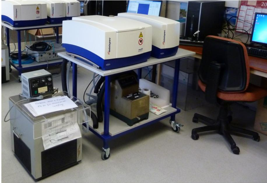
FIGURE 2.11 – Bruker Minispec MQ20 ND-Series du laboratoire Navier.
