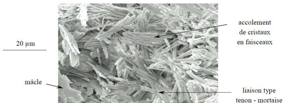
FIGURE 1.3 – Micrographie d'un faciès de plâtre pris ( $E/P = 0,8$ ) [2]
