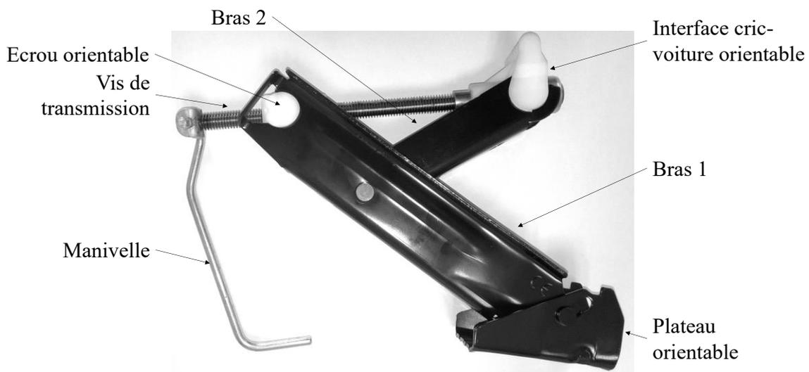
Figure 29. Photo du cric mécanique de voiture
