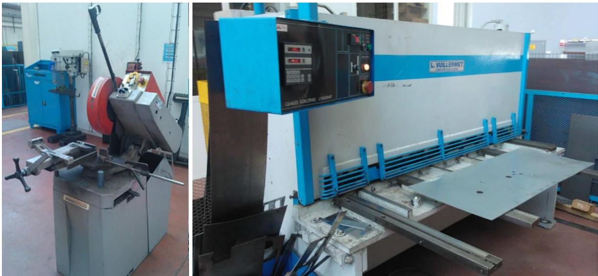
*Figure 71. Visuels de la tronçonneuse (à gauche) et de la cisaille (à droite)*
