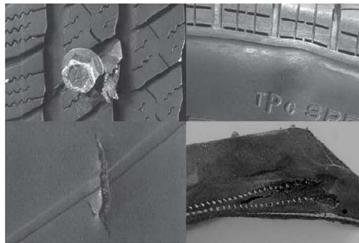
Figure I.2 Endommagement d'un pneu par choc
