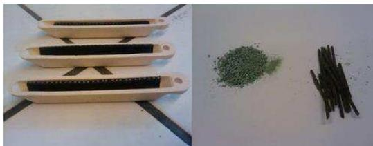
Figure II.14 Eprouvettes avant et après brûlées
