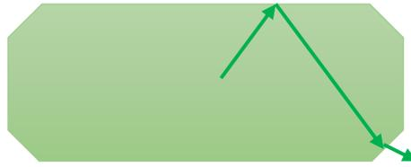
*Figure III-26 : Effet des coins sur le guidage des rayons.*
