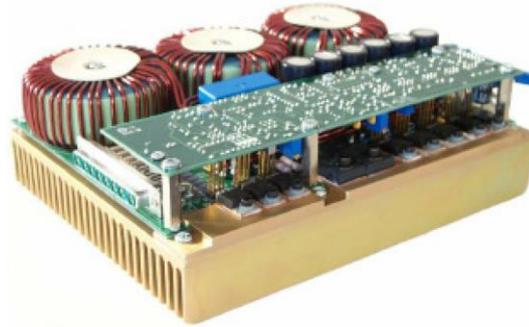
Figure II-19 : Alimentation PCO-6131 (Directed Energy, Inc) utilisées pour les LEDs ambre et IR.
