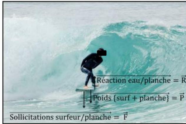
Figure 30 : Sollicitations mécaniques extérieures s'exerçant sur une planche
