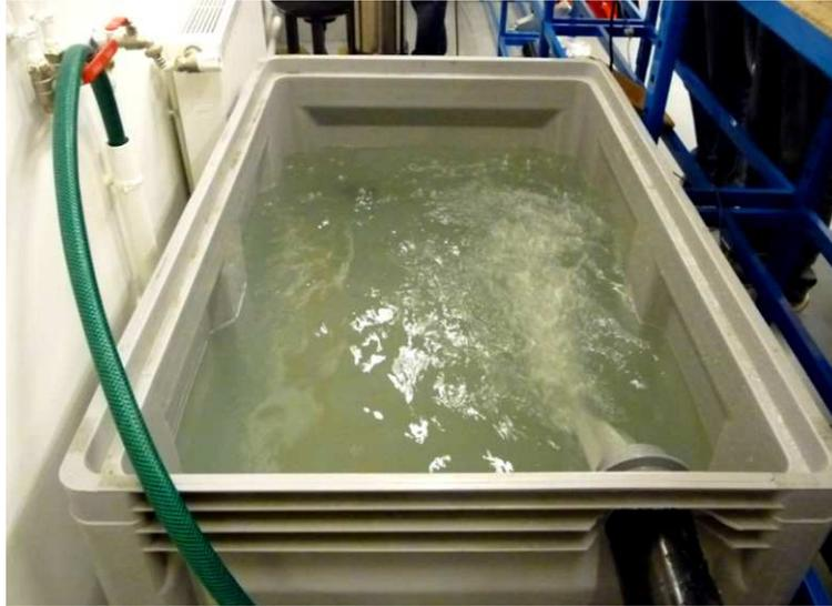
**Figure II-13 Réservoir d'alimentation de la pompe**
