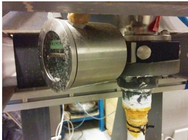
**Figure II-17** Photo du turbidimètre *Kobold LAT N1*
