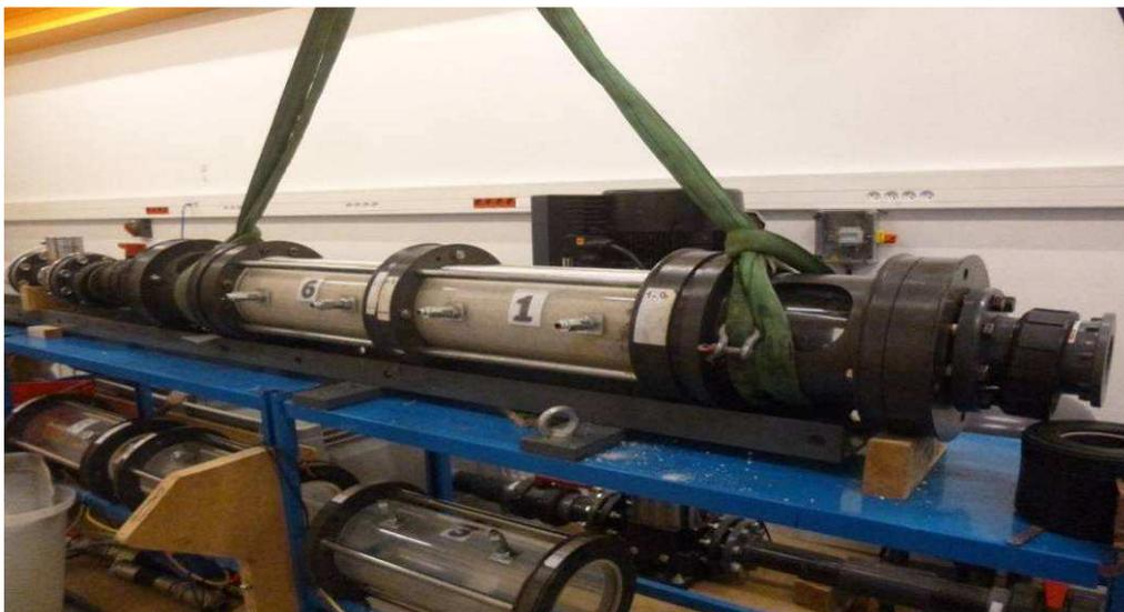
**Figure II-34 Installation de la conduite sur son support**
