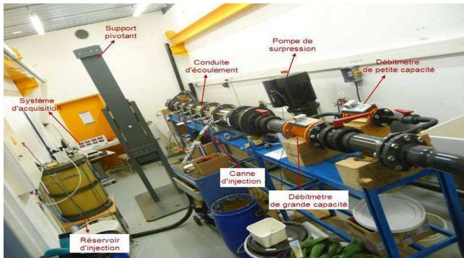
**Figure II-3** Vue d'ensemble du dispositif initial d'essai (Truong 2012)
