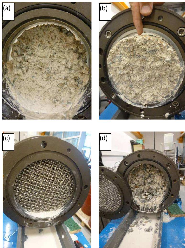
**Figure III-8 Photos prises au cours de démontage de l'essai EH2 sur le matériau  $AS_pSG2$  : (a) et (b) Illustration au démontage du vide créé sur la partie supérieure de la conduite; (c) et (d) Dépôt du sol érodé dans le fond du module aval.**
