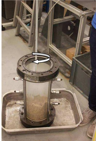
**Figure II-31 Compactage rotatif du sol par couches successives**
