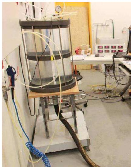
**Figure II-14 Réservoir de saturation dans la configuration verticale**
