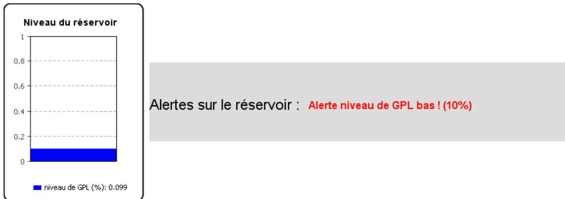
**Figure 5-10 Alerte de niveau bas sur le réservoir.**
