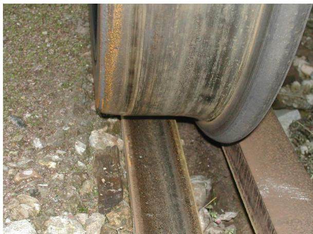
FIGURE 1.20 – Passage dans les appareils de voie
