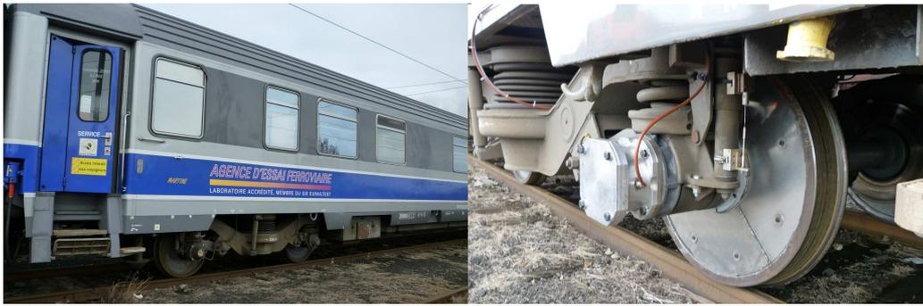
FIGURE 4.5 – Train et essieu instrumenté
