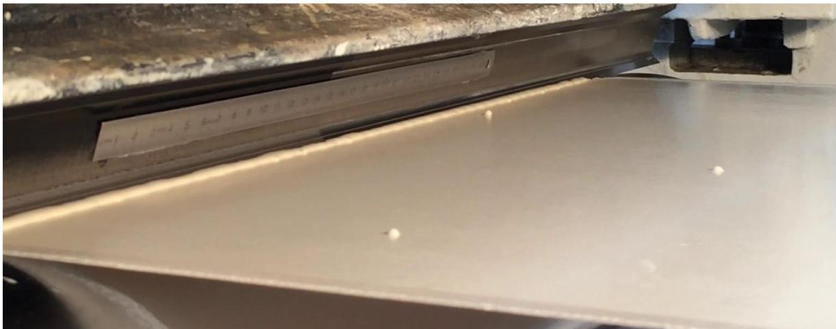
Figure 102 : Apparition de gouttes en aval de la racle, relarguées sur le substrat
