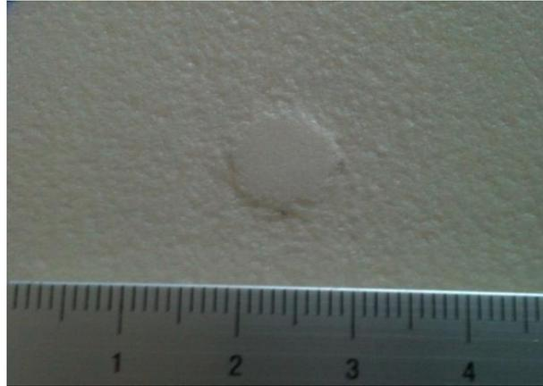
Figure 12 : Défaut de gouttes sur un produit fini
