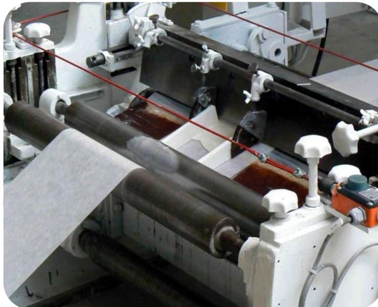
**Figure 99 : Photo de l'enduseuse racle pilote de Wiltz**
