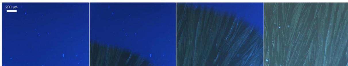
**Figure 1-23 :** Photographies prises avant, pendant et après la transition  $N \rightarrow Cr$  de l'échantillon 6OCB:CUB-CBP<sub>0,01</sub>. La source d'excitation est une lampe à vapeur de mercure équipée de filtre laissant passer les longueurs d'onde comprises entre 330 nm et 380 nm.
