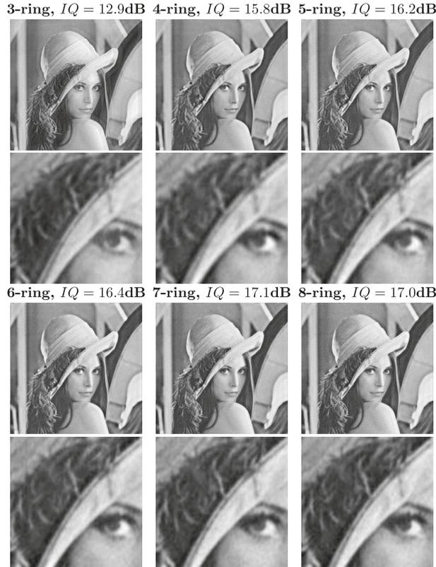
FIGURE 4.28: Image et zoom de l'image de Lena obtenus avec le système hybride simulé pour la défocalisation  $\psi = \psi_{\max}$  et des masques optimisés pour  $\psi_{\max} = 2.0\lambda$  et pour un nombre d'anneaux croissant.
