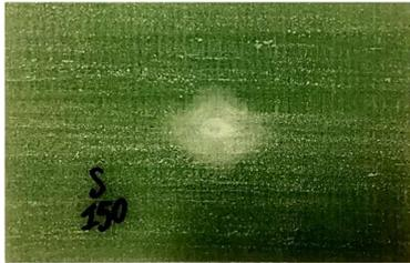
(e) Sandwich avec mousse PET 200 Kg/m<sup>3</sup>
