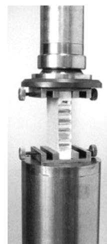
(b) Configuration du test de compression longitudinale
