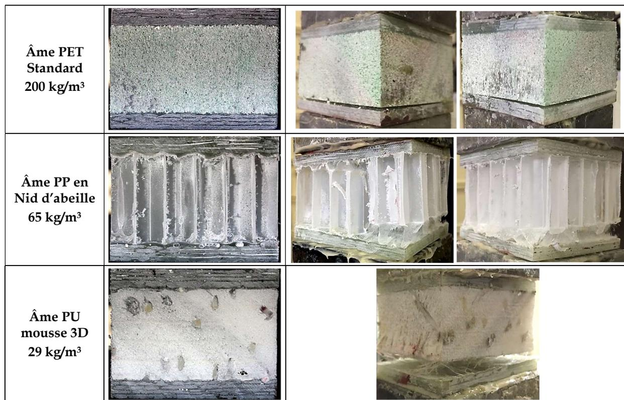
Figure III-134 : Evolution de l'essai de traction perpendiculaire.
