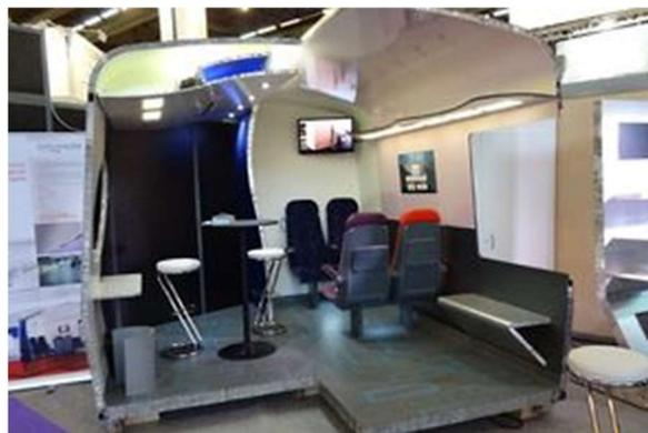
Figure I-8 : Un concept-train en "panneau sandwich".
