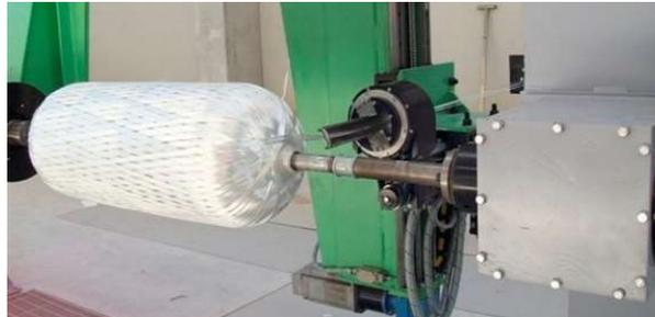
Figure I-41 : Enroulement polaire ou satellite.
