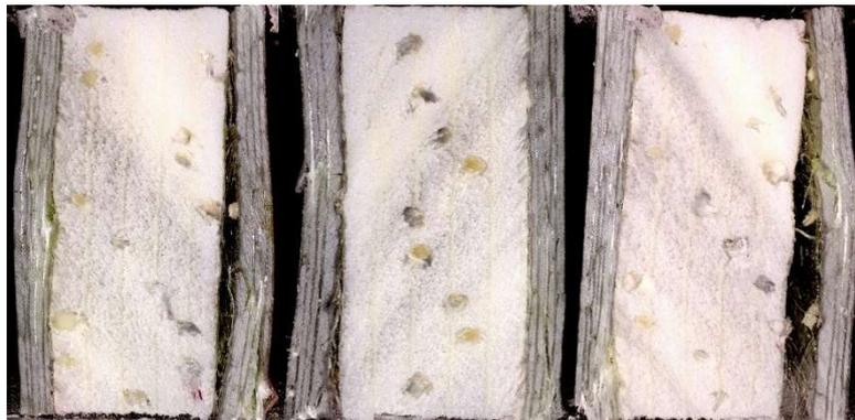
Figure III-169 : Les différents modes de rupture observés en compression longitudinale pour tous les sandwich.
