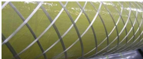
Figure I-40 : Illustration d'un enroulement hélicoïdal à  $55^\circ$ .
