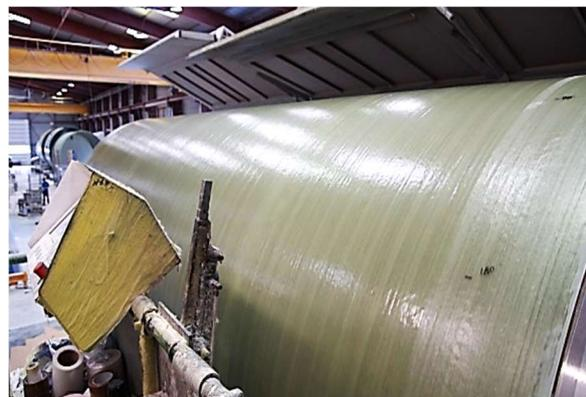
Figure II-49 : Enroulement d'une couche de fibres [Plasticon Composites].
