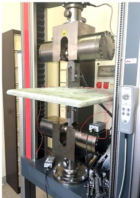
Figure III-184 : Dispositif de l'essai de résistance à l'arrachement.
