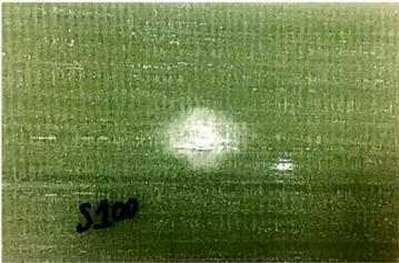
(d) Sandwich avec mousse PET 150 Kg/m<sup>3</sup>
