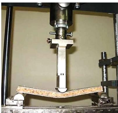
(b) Exemple d'essai réel de flexion 3 points
