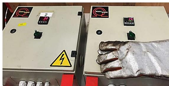
Figure II-86 : Régulateurs de température reliés aux couvertures chauffantes.
