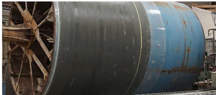
Figure I-38 : Mandrin d'une machine d'enroulement filamentaire [Plasticon Composites].
