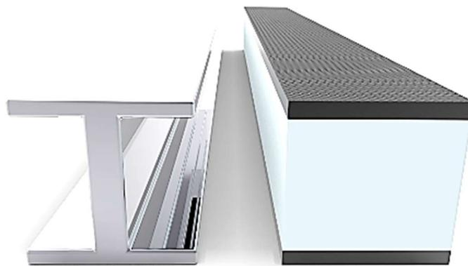
Figure II-47 : Exemple d'équivalence de géométrie entre une forme en acier et sandwich.
