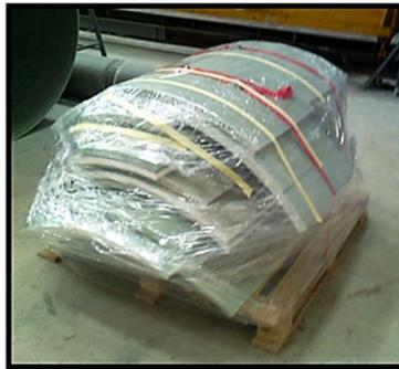
Démoulage du cylindre enroulé, découpage des plaques et mise en palette de l'ensemble
