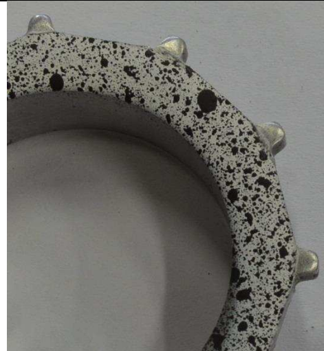
Fig.III.5: pinion painted before testing // peinture appliquée sur le pignon avant essais
