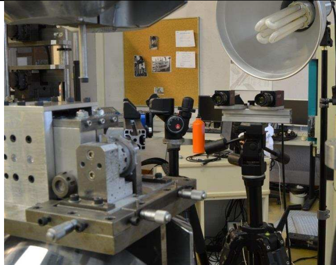
Fig.III.4: DIC system VIC® set up in front of the test bench // système de corrélation d'images 3D VIC® installé devant le banc d'essai
