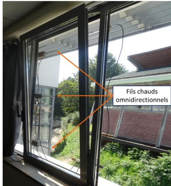
Figure 57: fils chauds omnidirectionnels pour la mesure du profil vertical de l'air au niveau de la fenêtre
